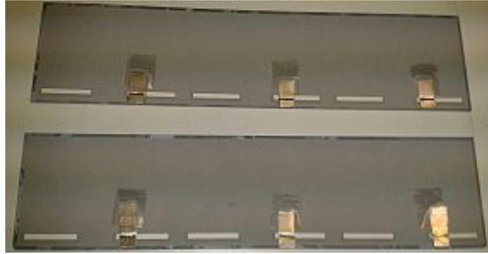
(b) Zellen mit Verbindungsstücken deren Prägung genau in Mulde der rückseitigen Kontaktflächen liegt.
