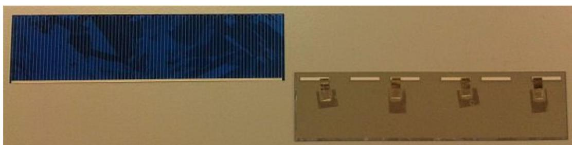
Abbildung 73: Front- und Rückseite einer speziellen Quartercell, die Rückseite bereits mit den mittels Klebeband PPI 1040W aufgeklebten Kontaktstreifen. Diese QuarterCell ist Typ „P“, wie schon von den Minimodulen bekannt.
