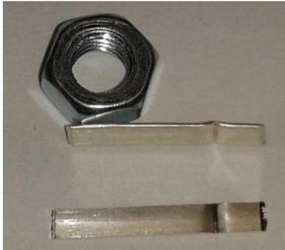
Abbildung 29: HA9: Verbindungsstücke aus Cu-Band versilbert, 0,3 x 2,2 x 15,0 mm, mit Prägung
