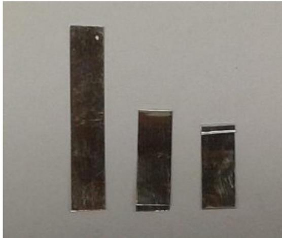
Abbildung 21: HA3 Kontaktstreifen: Rechts ist der fertige Kontaktstreifen, dessen oberes Ende wegen der doppelten Faltung eine Dicke von 0,2mm hatte. Dieser etwa 1mm breite Bereich stellt den eigentlichen Kontakt zwischen den Zellen her. Die restlichen etwa 10mm Länge des Streifens dienen nur dem einfachen Auflegen bei der Herstellung.
