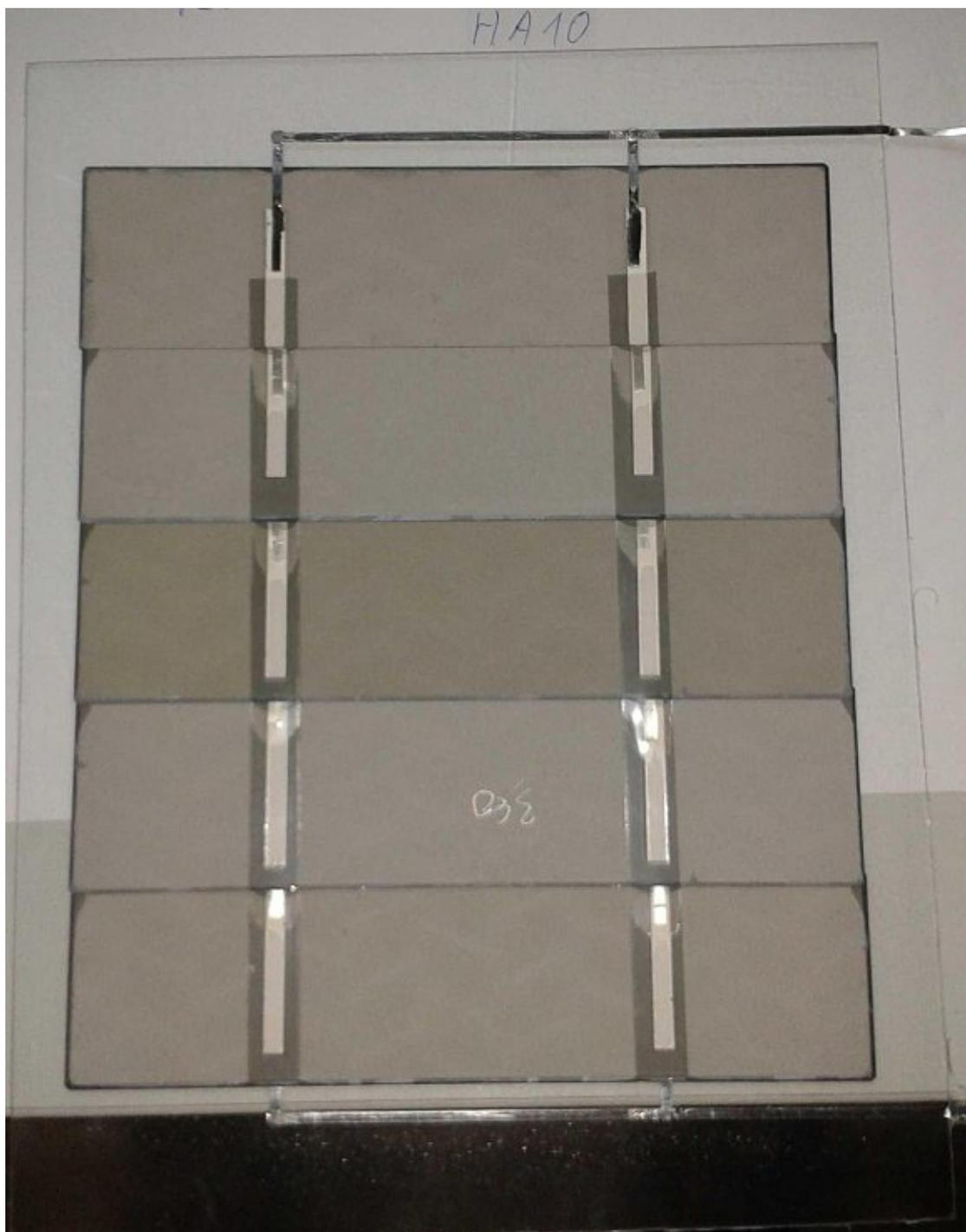
Abbildung 31: HA10 Rückansicht nach der Lamination. Die Rückseite ist offen, damit ein Höhenprofil der Verbiegung der Zellen aufgenommen werden konnte, die durch die Überlappung und dazwischen gelegte Kontaktstreifen zustande kommt.
