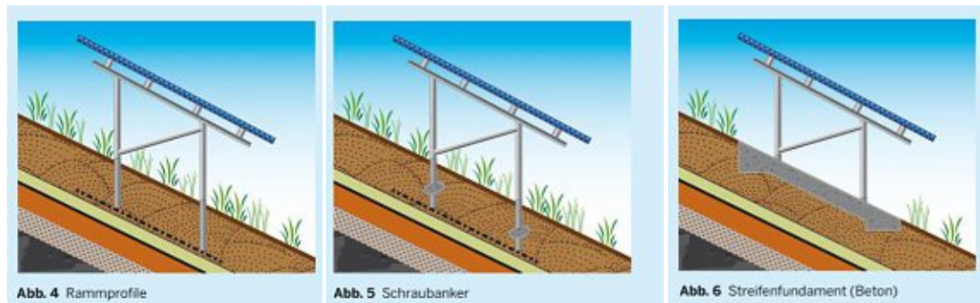
Abbildung 7: Gründungsvarianten für die Aufständigung von PV-FFA
