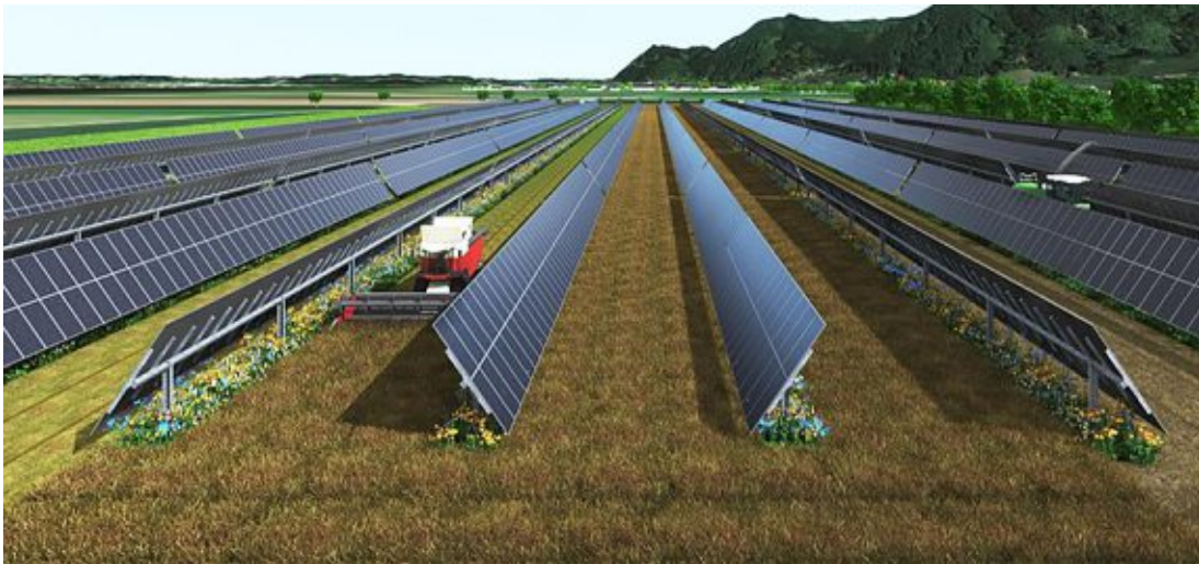
Abbildung 22: Modell einer einachsigen nachgeführten Anlage (Ost-West-Richtung) mit landwirtschaftlicher Nutzung
