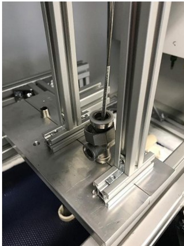
Abbildung 7: Thermoelemente 1-4, die mit einer Feder zusammengehalten werden
