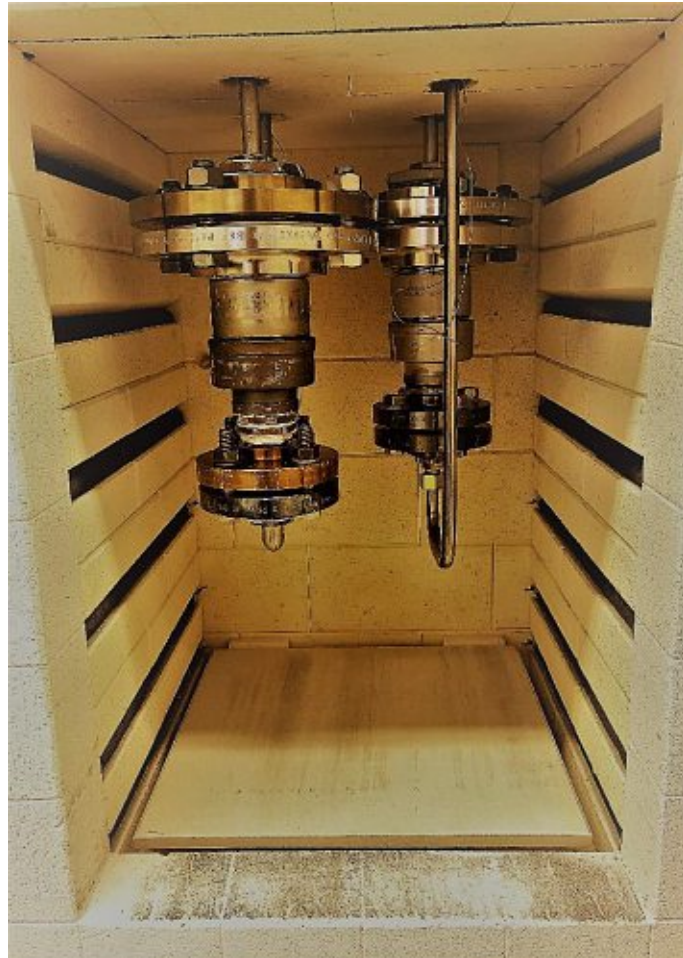
Abbildung 6: Heizraum des Ofens (KITTEC) mit den beiden Reaktoren
