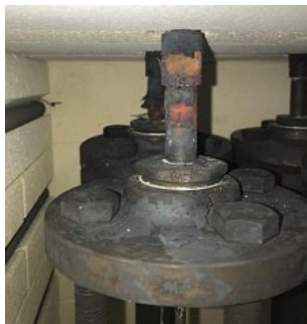
Abbildung 16: Edelstahlreaktoren die bei Temperaturen bis 850 °C verwendet wurden
