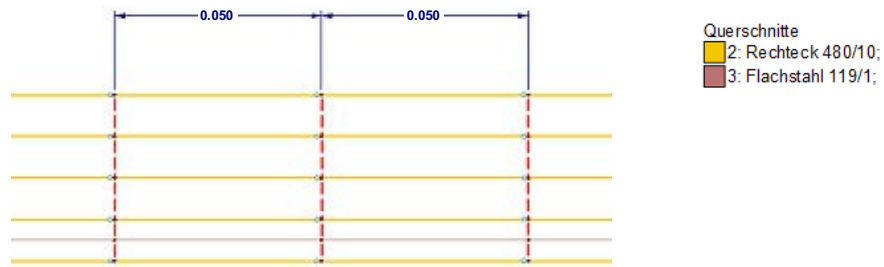
Abb. 4.9: Modellbildung Stahlbetonträger: Berücksichtigung von Zustand II - Modellbildung für die Stahlbetonschicht
