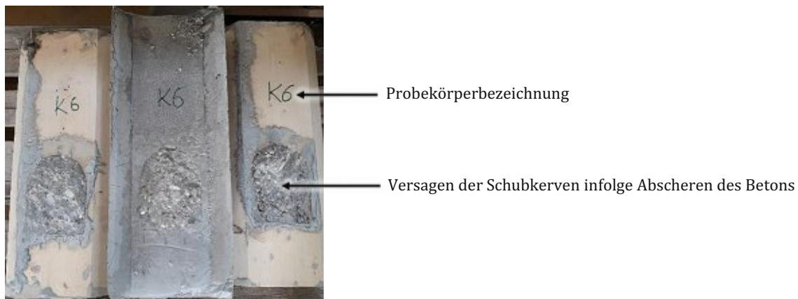
Abb. 3.22: typisches Versagensbild der Versuchsreihe „K“
