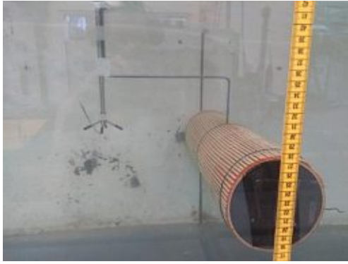
Abbildung 20: Zylinder mit Geschwindigkeitsmessgerät und Abstandhalter.
