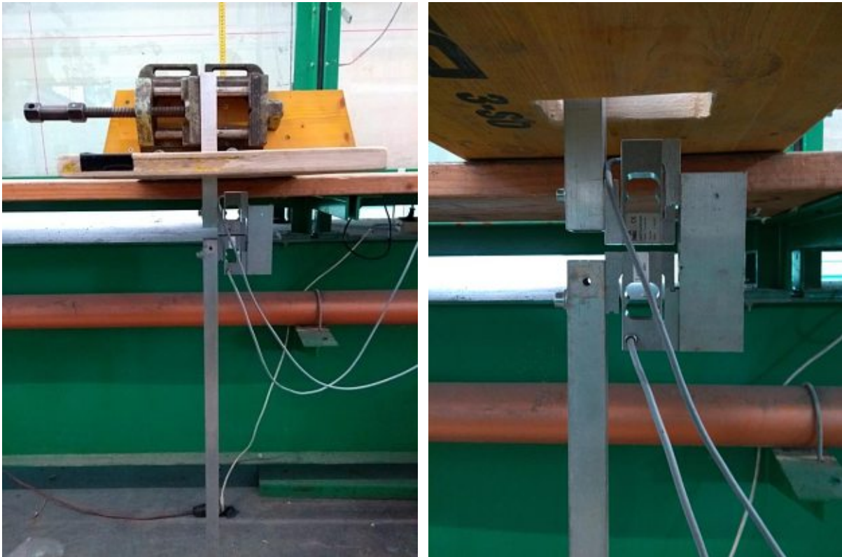
Abbildung 29 (a) Ansicht des Kalibrieraufbaus und (b) Detailansicht der Messzellen.
