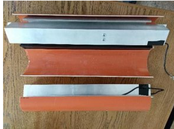
Abbildung 15: Innenbereich eines Messzylinders mit Schiebevorrichtung.
