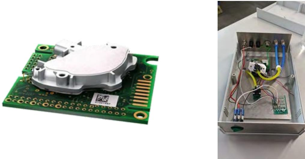
Abbildung 3.2: Links ist schematisch der CO<sub>2</sub>-Sensor dargestellt [62] und rechts ist ein Foto des Sensors inklusive Verkabelung in der fertigen Messzelle.
