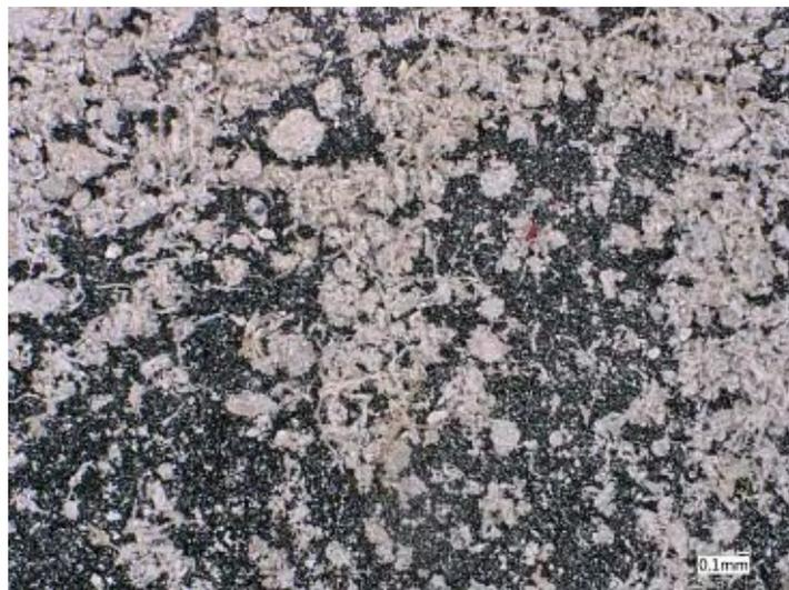
Abbildung 2.5: Mikroskopaufnahme des Papierfangstoffes, der vom Industriepartner als Porosierungsmittel verwendet wird.
