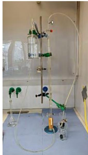
Abbildung 3.3: Schema (li.) und Foto (re.) des verwendeten Scheibler-Geräts zur Bestimmung des TIC der Proben.
