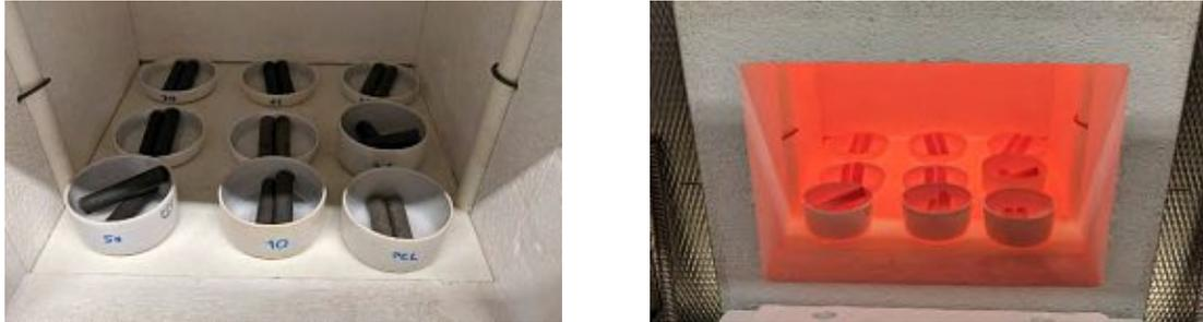
Abbildung 4.1: Proben am Anfang (li.) und Ende (re.) des Temperaturrampenversuchs zur Bestimmung der Porosität.
