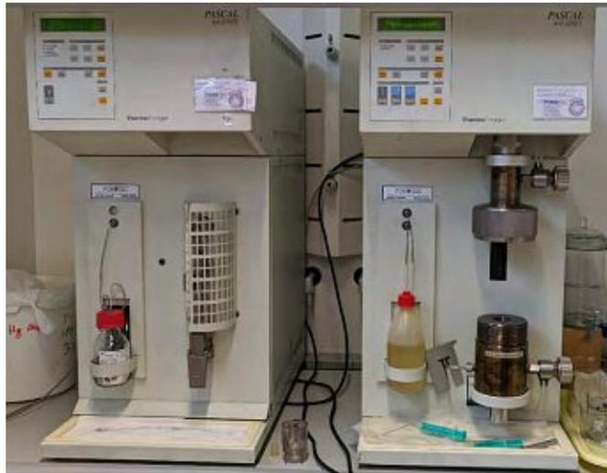
Abbildung 3.5: Verwendete Apparaturen zur Durchführung der Quecksilberporosimetrie. Links ist das Niederdruckmessgerät *Pascal 140* und rechts das Hochdruckmessgerät *Pascal 440* zu sehen.
