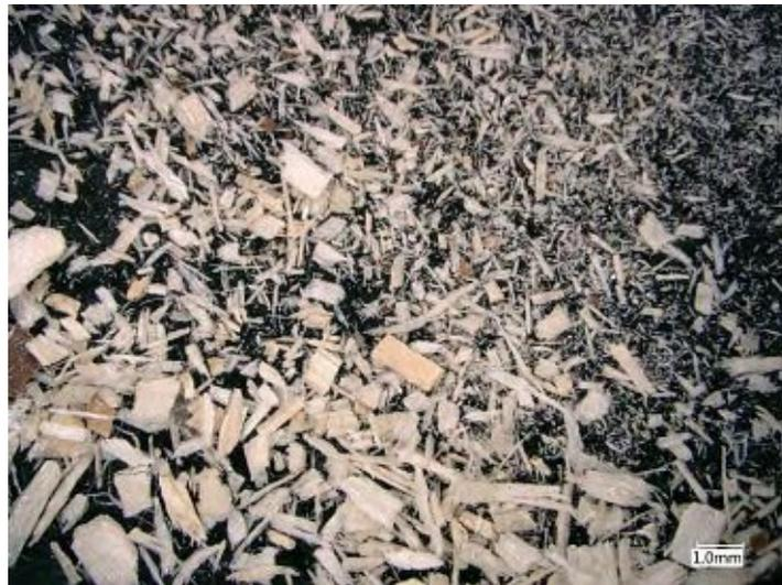
Abbildung 2.4: Mikroskopaufnahme der Sägespäne, welche vom Industriepartner als Porosierungsmittel verwendet werden.
