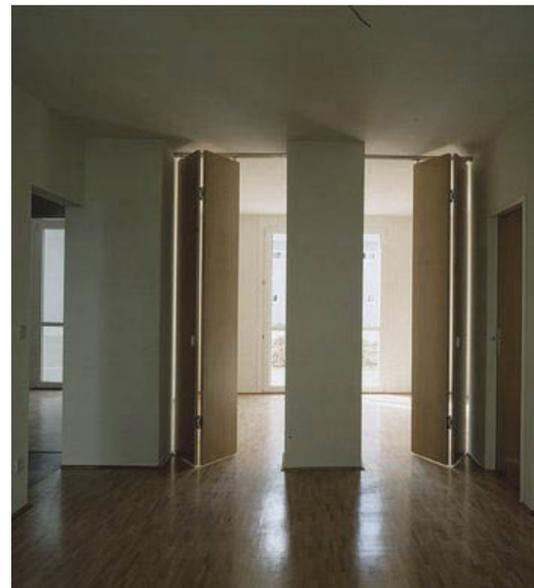
Abb. 75 Falttüren ermöglichen Zirkulation
