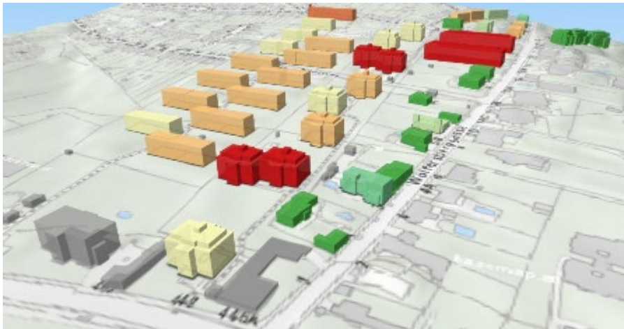
Abb. 2: Modellergebnis Heizwärmebedarf auf der Grundlage von Gebäudeform, Bauperiode und Klima für ausgewählte Bebauungsstrukturen in Wien. Quelle: Brus, T. und Kalasek R. (2020)
