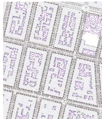
Abb. 3: Angebotspotenziale Erdwärmesonden/Modellierung potenzieller Bohrlochstandorte zur Abschätzung des Erdwärmepotentials im Rahmen der Anergie-Studie Anergie Urban. Links: Potenzialflächen für Bohrungen, rechts: Ausschnitt: Modellierung Bohrlochverteilung. Quelle: Brus, T. und Kalasek R. (2020)
