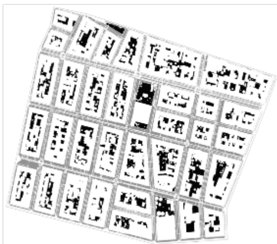
Abb. 3: Angebotspotenziale Erdwärmesonden/Modellierung potenzieller Bohrlochstandorte zur Abschätzung des Erdwärmepotentials im Rahmen der Anergie-Studie Anergie Urban. Links: Potenzialflächen für Bohrungen, rechts: Ausschnitt: Modellierung Bohrlochverteilung. Quelle: Brus, T. und Kalasek R. (2020)
