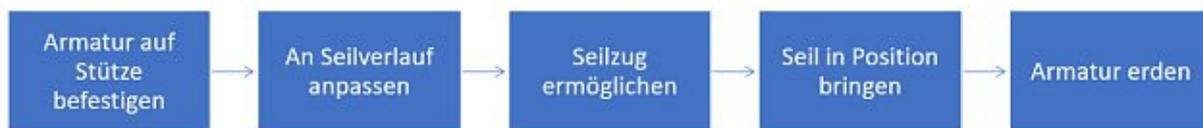
Abbildung 33: Funktionsstruktur für die Montage des Systems
