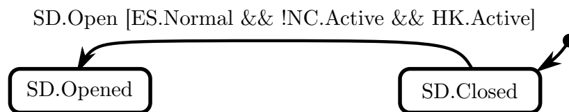
Abbildung 5.6: Zustandsautomat aus einem Programmabschnitt einer Speicherprogrammierbaren Steuerung (SPS).
