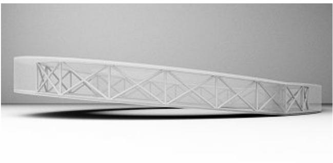
Raster zwei ist aus dem Zentrum der Ellipsen aufgebaut und in gleichmäßige Abstände unterteilt. Die Ausarbeitung der Fachwerkststäbe wurde zur Vergleichbarkeit in den selben vier Varianten durchgeführt wie bei Raster 1.
