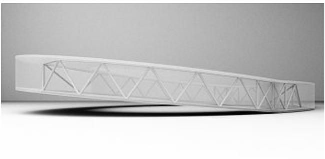
Bei Raster eins liegen die Konstruktionspunkte auf Achsen die parallel zur Kippachse sind und in regelmäßigen Abständen zueinander stehen. Die Ausarbeitung der Fachwerkstöße wurde in vier Varianten durchgeführt.
