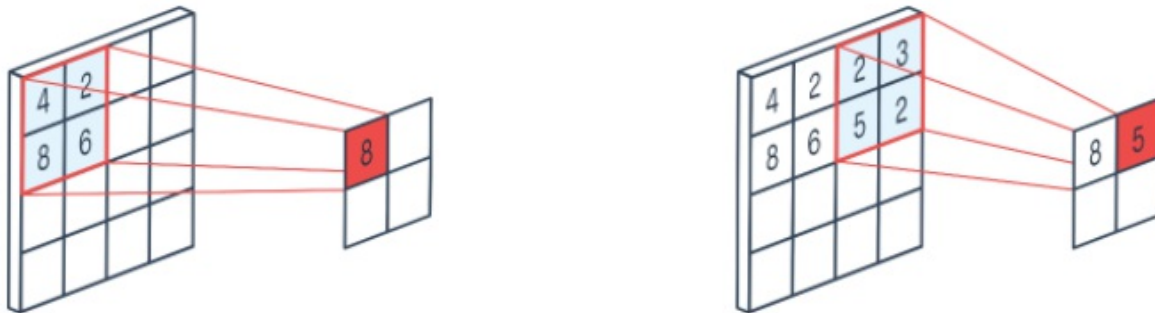
Abbildung 13: 2D Max Pooling Operator ; Bildquelle: (Peltarion, 2020b)
