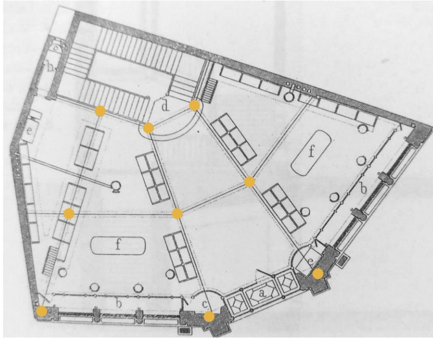
Abb. 28: Sicardsburg&v.d.Nüll, Haas-Haus, Grundriss Parterre Pfeilerraster, Stephansplatz Wien, 1867
