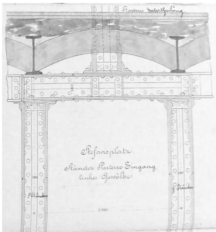
Abb. 25: Fellner&Helmer, Rothberger, Detail Pfeilerkonstruktion, Stephansplatz Wien, 1886
