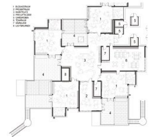
Abb.14: Grundriss Grundschule Bildungscampus Sonnwendviertel in Wien (Ö)
