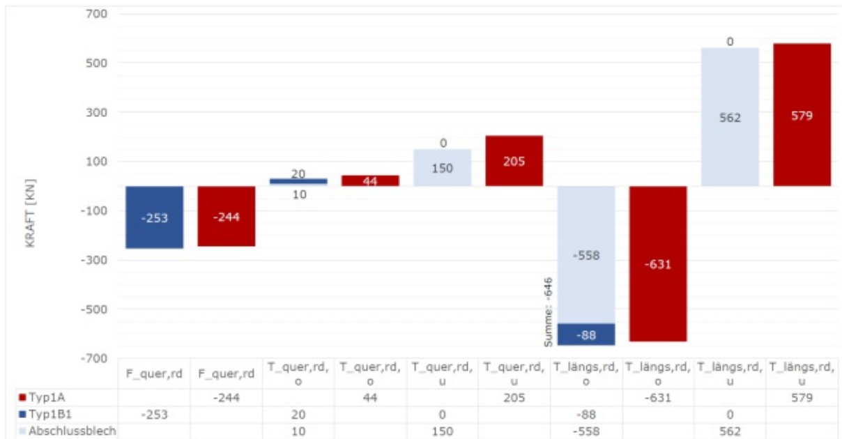
Abb. 5.60: Vergleich der auf den Randbereich wirkenden Kräfte der Modelle Typ A und B
