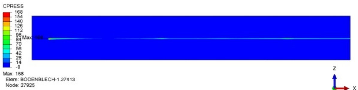
(a) Kontaktspannungen im Bodenblech
