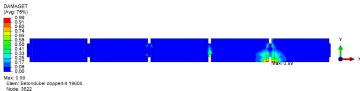
Abb. 5.38: Typ1B1_4500_ULS: Betonzugschädigung der Platte geschnitten durch Dübel G
