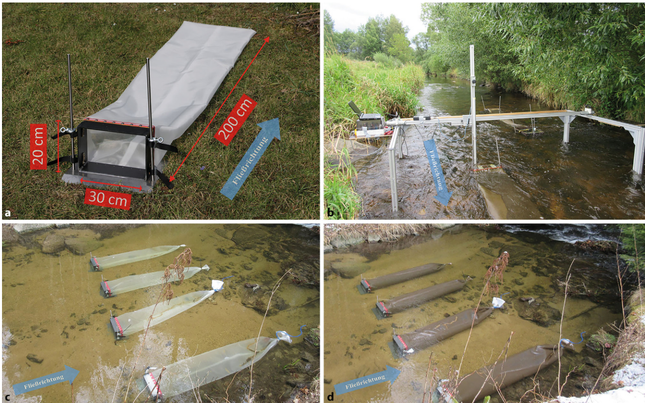
Abb. 2 a Adaptierter Geschiebesammler nach Bunte et al. (2007) und b Messungen der Fließgeschwindigkeiten im Nahbereich der Sammler mittels zylindrischer Flügelradsonde (Durchmesser 25 mm). Fotos der ersten Tests zur Sammelkapazität: c aufgenommen nach Einbau der Sammler und d Zustand 24 h nach dem Einbau
