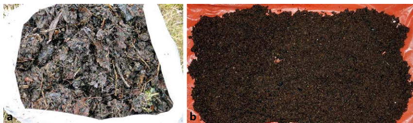
Abb. 5 Beispiele von gesammeltem organischen und anorganischen Material aus dem SOA-Sammler: a überwiegend Blätter und Äste, die in Form von Schwimmstoffen aus der fließenden Welle gesammelt werden (Zubringer durch Forstwirtschaft geprägt); b überwiegend Feinmaterial (Korngrößen <2 mm)
