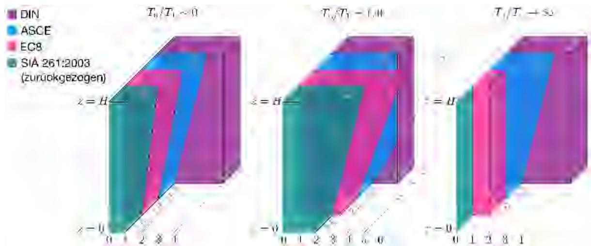
Bild 2.3: Übertragungsfaktoren der einwirkenden Bodenbeschleunigung in Bodennähe  $z = 0$  und Dachhöhe  $z = H$  für die Periodenverhältnisse  $T_a/T_1 \sim 0$ ,  $T_a/T_1 = 1,0$  und  $T_a/T_1 \rightarrow \infty$
