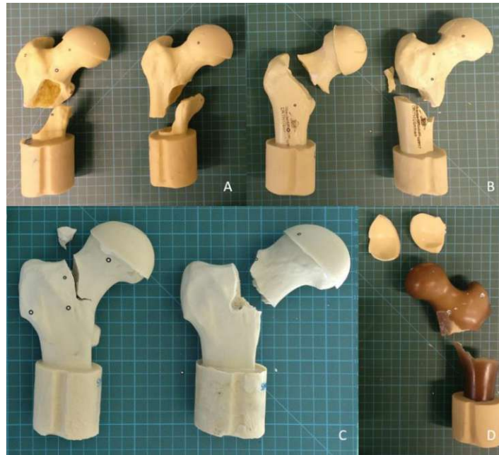
Figure 58: Fracture pattern of artificial bones. (A) OBS (B) OB (C) SYN (D) SAW
