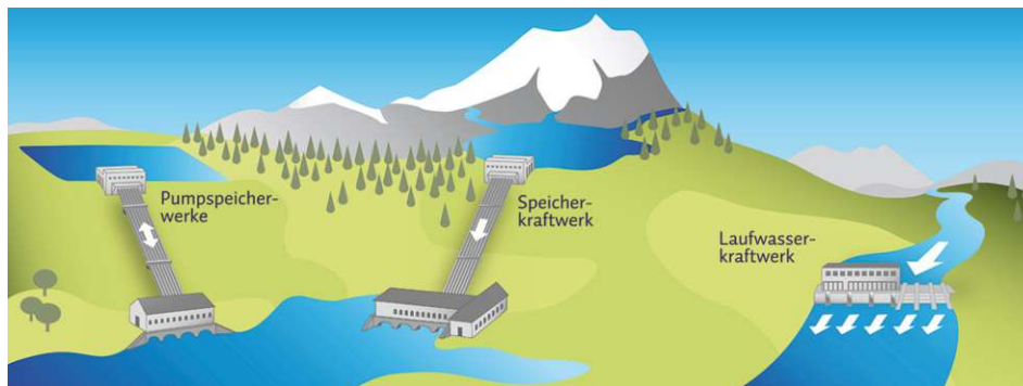
Abbildung 2.2: Arten von Wasserkraftwerken [7]
