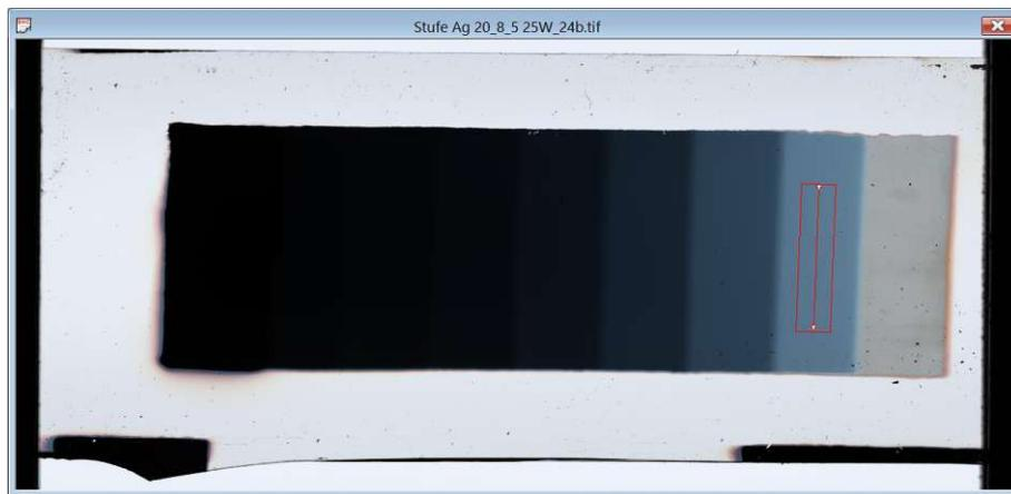
**Abbildung 5-39 Ansicht einer Ag Stufenprobe im Anzeigefenster von ThinFilmInspect mit Linescan über eine Stufe**
