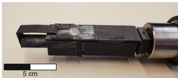
Abbildung 5-3 Foto des Substrathalters für die Sputteranlage
