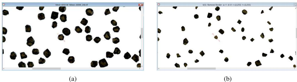
**Abbildung 4-18** Anzeigefenster (a) vor und (b) nach einer Randentfernung von 10 Pixel ohne Entfernung dunkler werdender Objekte
