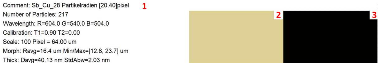
**Abbildung 7-30 Header eines Particel Pic, eingeteilt in 1) das Datenfeld, 2) Kalibrationspunkt T1, 3) Kalibrationspunkt T2**
