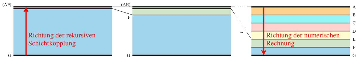
Abbildung 12-4 Rekursive Auflösung eines Mehrschichtsystems mit den Interfaces A-G, welches zuvor in ein 2-Interface System mit den Interfaces (AF) und G vereinfacht wurde. (In Klammern gesetzte Interfaces beschreiben wiederum Mehrschichtsysteme)
