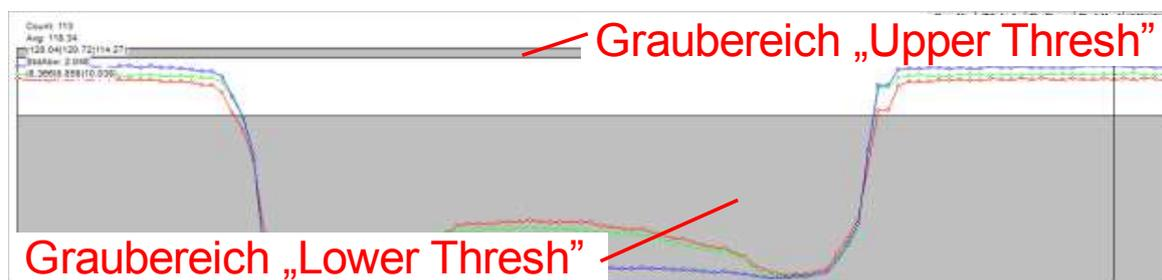
**Abbildung 5-2 Graphenfenster im Linescan Modus mit aktiven "Lower Thresh" und "Upper Thresh"**
