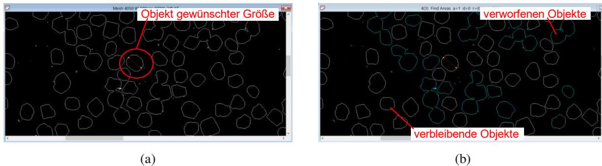
**Abbildung 4-15 (a) Binärbild nach Kantendetektion; objekte gewünschter Größe sind mittels Linescan gekennzeichnet (b) Binärbild nach der Operation „Find Areas“; verworfenen Objekte sind mit grünem Rand gekennzeichnet**
