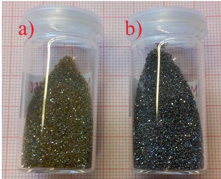
**Abbildung 6-2 Diamantgranulat QM MBD4 Mesh 40/50 in Probenbehälter a) unbeschichtet b) Ag beschichtet (Maßstab im Hintergrund in mm)**
