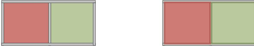
Abbildung 3.2: Auf der linken Seite ist das Raumvolumen mit der Berechnungsmethode *At wall finish* und auf der rechten Seite mit *At wall center* dargestellt.
