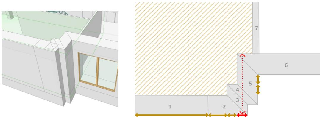
Abbildung 5.12: Komplexe Außenwand, die aus mehreren *IfcWall*-Elementen besteht
