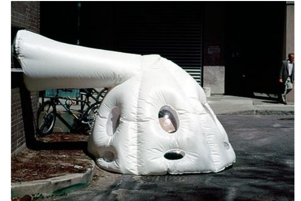
Abb. 33. Bill S.'s paraSITE Unterkunft. Er forderte so viele Fenster wie möglich, denn "Obdachlose haben keine Probleme mit der Privatsphäre, aber sie haben Probleme mit der Sicherheit. Wir wollen potenzielle Angreifer sehen, wir wollen für die Öffentlichkeit sichtbar sein." Sechs Fenster befinden sich auf Augenhöhe, wenn Bill sitzt, und sechs kleinere Fenster, wenn er liegt.
