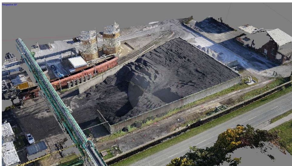
Abb. 3.25: Photogrammetrische Aufnahme eines Haufwerks mit jalasca [160]
