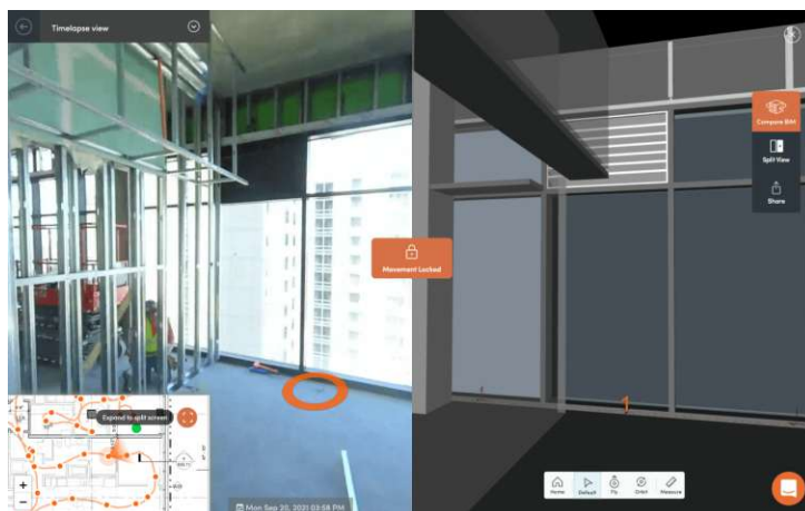
Abb. 3.28: Vergleich zwischen 360°-Aufnahme und BIM-Modell mit StructionSite [173]
