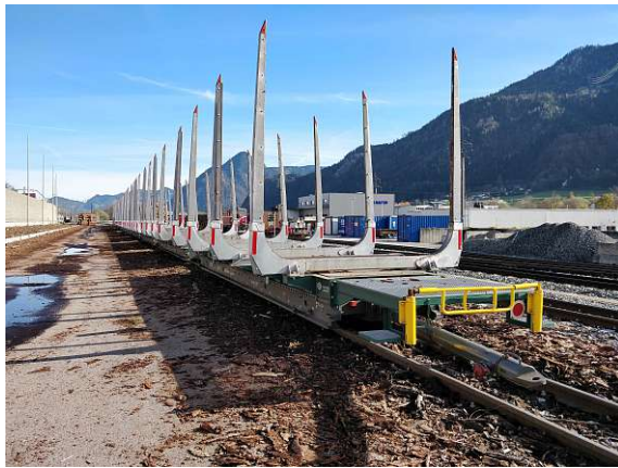
(a) Rollwagen mit aufgesetzten Rungenaufbauten
