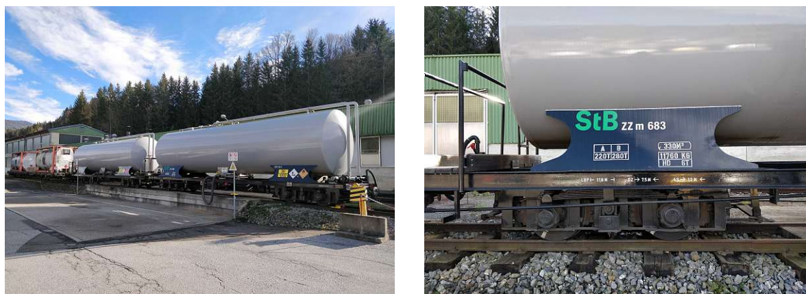
(a) Kesselwagen Type ZZm und Containertransportwagen Type SSrm (b) Aufschriften am Kesselwagen der Type ZZm
