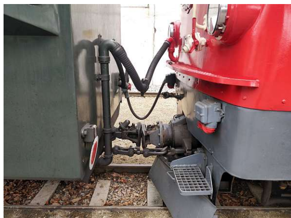
(a) Bosnakupplung mit zusätzlichen seitlichen Schraubenkupplungen im gekuppelten Zustand (Waldviertel, 22.10.2022)
