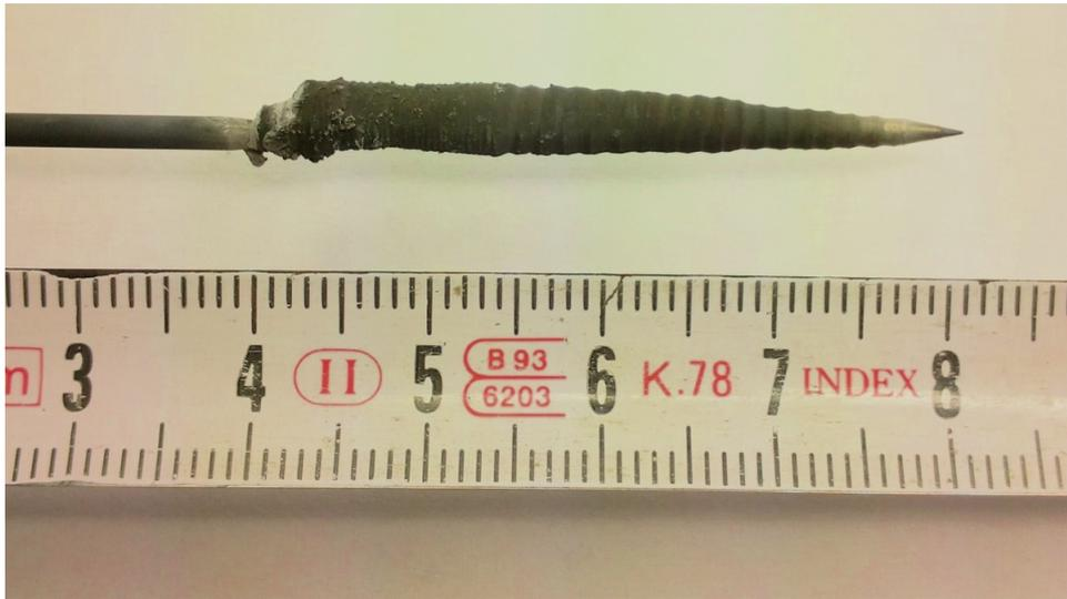
Abbildung 5.3: Der gezogene Kristall, noch mit der Zugspitze verbunden. Erkennbar ist das Fehlen eines relevanten Neckings im oberen (linken) Drittel.
