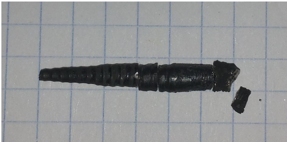
Abbildung 5.5: Der zersägte Kristall. Mittig befindet sich die 3 mm dicke Scheibe, am äußerst linken Ende das Ende des Zugversuches, rechts von der Scheibe der Anfang des Zugversuches.
