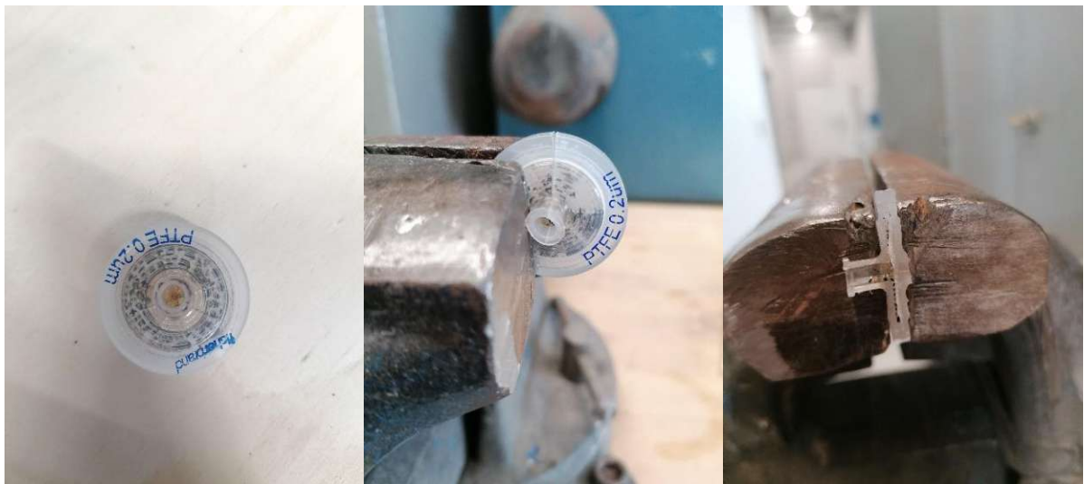
Abb. 13: Filter mit Asphaltene (links), Einspannen des Filters im Schraubstock (Mitte), Auseinanderschneiden des Filters (rechts)
