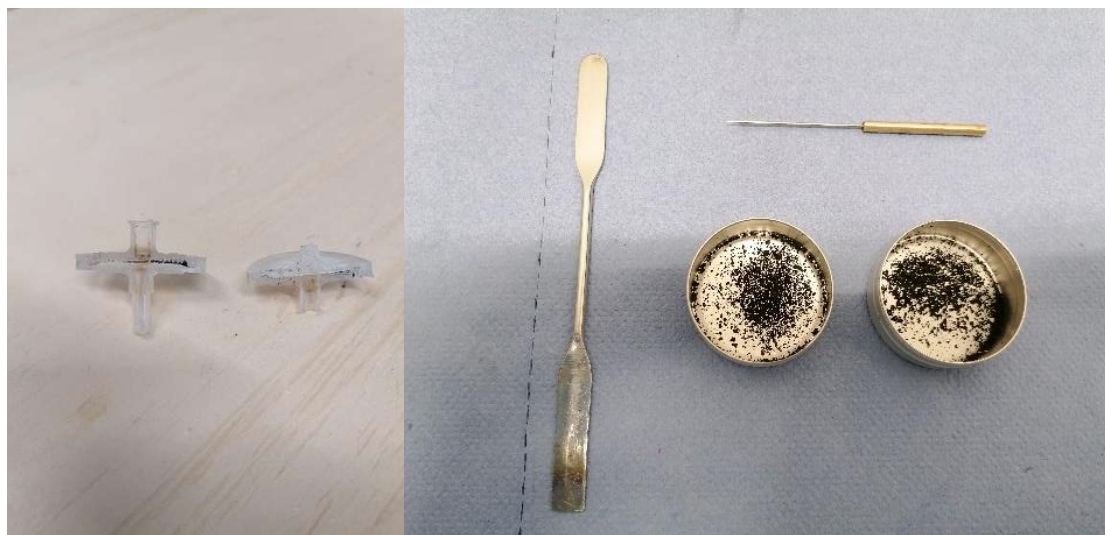
Abb. 14: Aufgeschnittener Filter (links), Herausgelöste Asphaltene (rechts)
