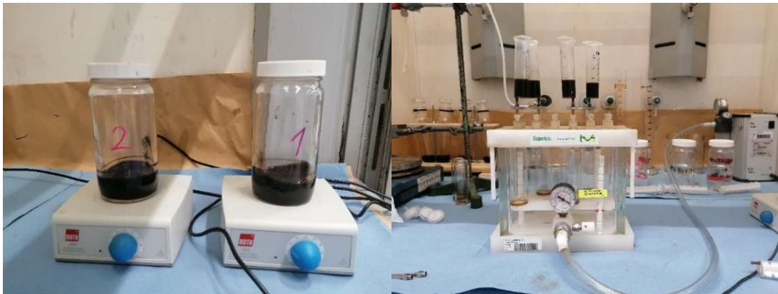
Abb. 12: 24 Stunden Rühren (Bitumen + Heptan) im Magnetrührer (links), Ausfiltern der Asphaltene mit Hilfe der Vakuumpumpe (rechts)
