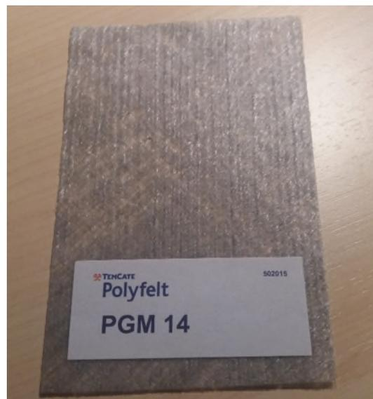
Abbildung 2-1 Asphaltvlies aus Glasfaser der Fa. Tencate
