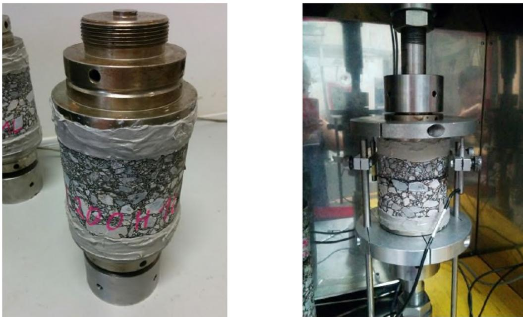
Abbildung 4-10 Probekörper vorbereitet für den Haftzugversuch, rechts Probekörper mit Asphaltbewehrung, eingespannt in der Prüfvorrichtung
