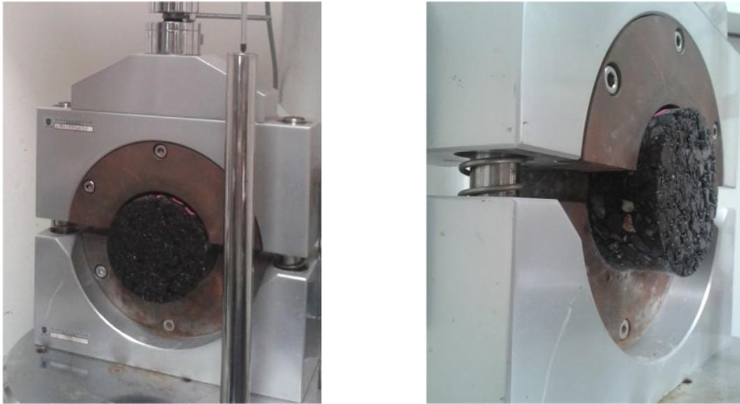
Abbildung 4-8 Scherversuch nach ÖNORM B 3639-1, [33]
