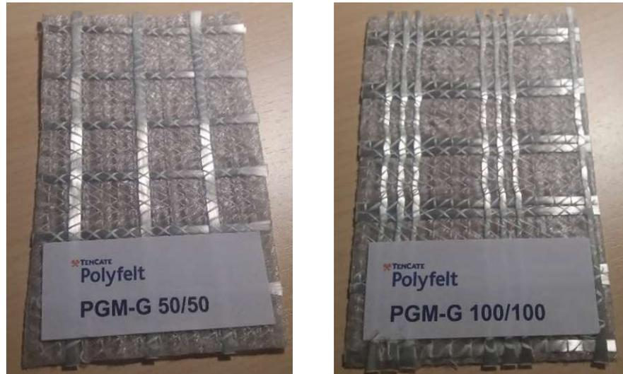
Abbildung 2-3 Kombinationsprodukt mit unterschiedlichen Stärken aus Glasfaser der Fa. Tencate
