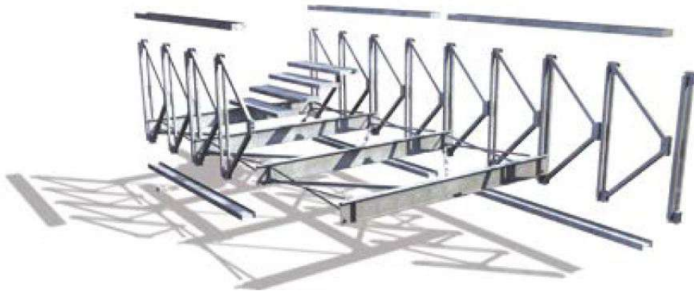
Abb. 3.5: Mabey Delta Brücke Tragwerk [43]
