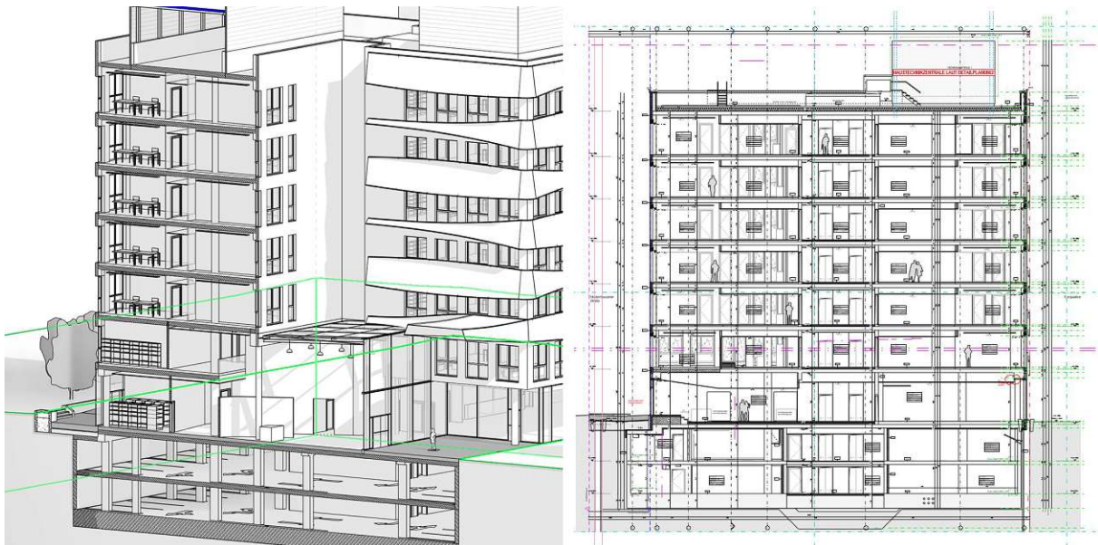
Abbildung 76: Datenmodell und abgeleitete Planansicht BIM, Projekt Zebra
