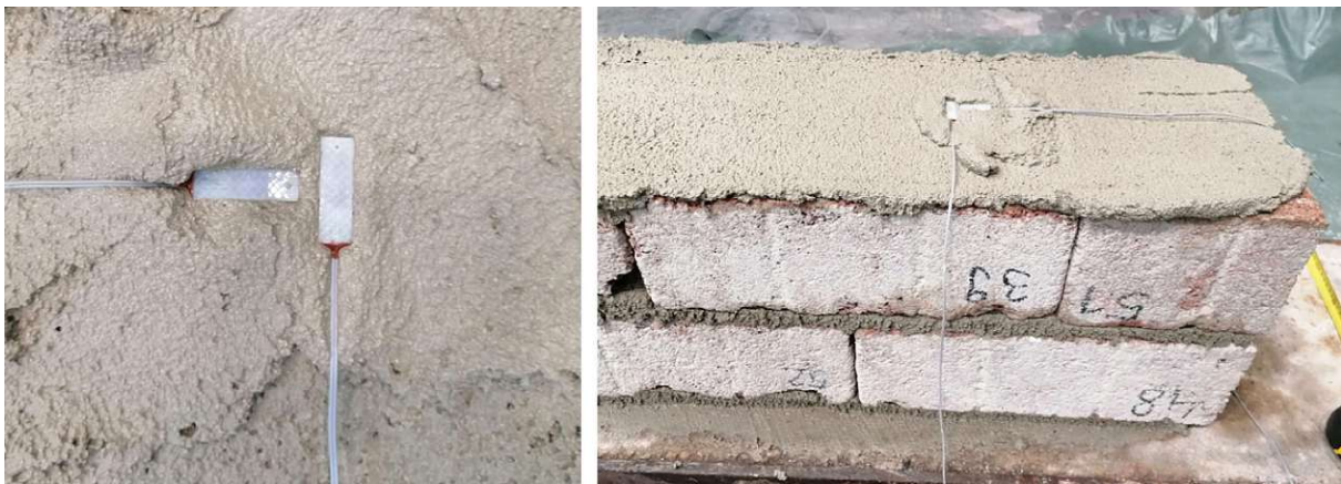
Abb. 5.28: Exemplarische Darstellung der DMS in der Lagerfuge
