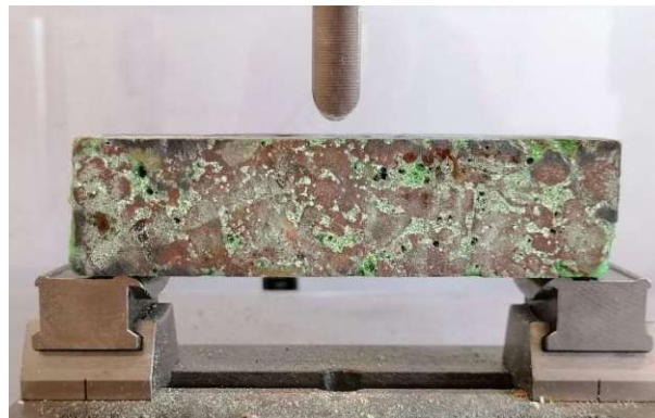
Abb. 5.21: Exemplarische Abbildung der 3-Punkt-Biegezugprüfung
