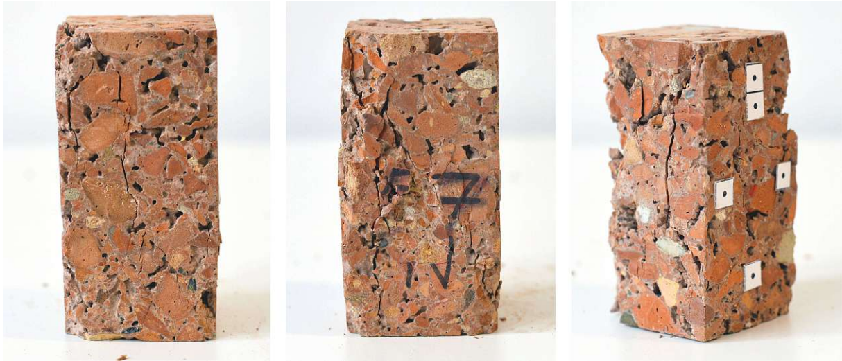
Abb. 5.17: Exemplarische Rissbildung bei Erreichen der Bruchlast der Kleinprüfkörper
