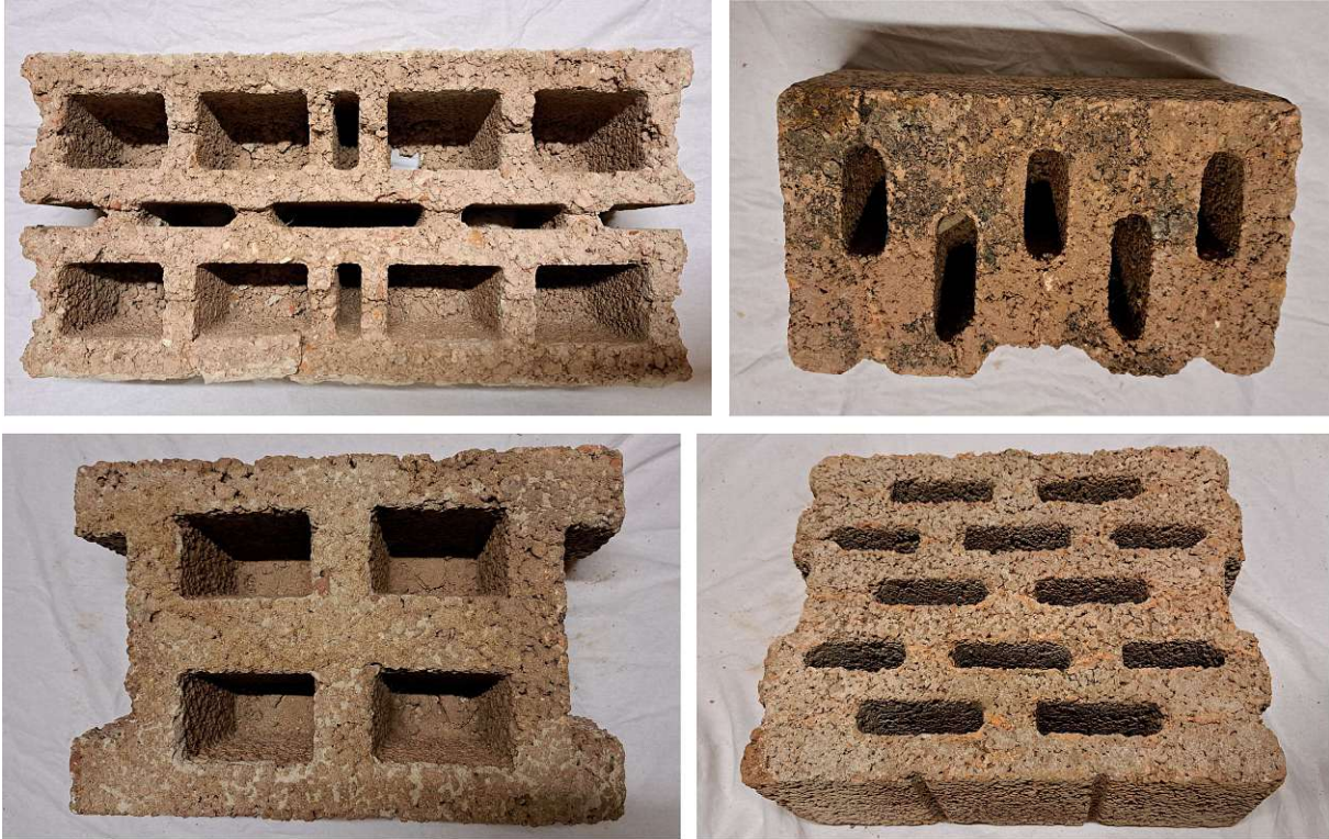
Abb. 3.4: Unterschiedliche Ziegelsplittbeton-Hohlblocksteine im Ziegelmuseum der Stadt Wien (Bezirksmuseum Penzing)
