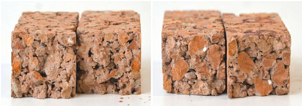
Abb. 5.19: Exemplarische Bruchbilder der Biegezugprüfung
