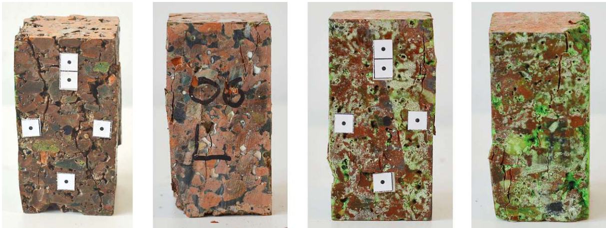
Abb. 5.20: Bruchbilder nach Prüfung der Druckfestigkeit: Verfestigung durch Hydropox EP1 (links) und Pur-O-Stop FS-M (rechts)
