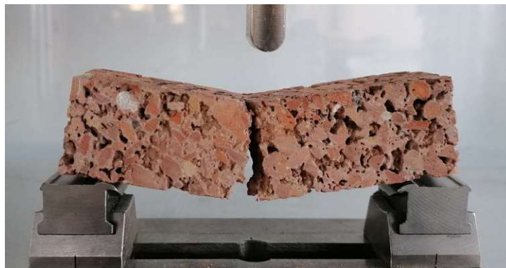
Abb. 5.18: 3-Punkt-Biegezugprüfung an Kleinprüfkörpern mit den Maßen 3 \times 3 \times 12 cm
