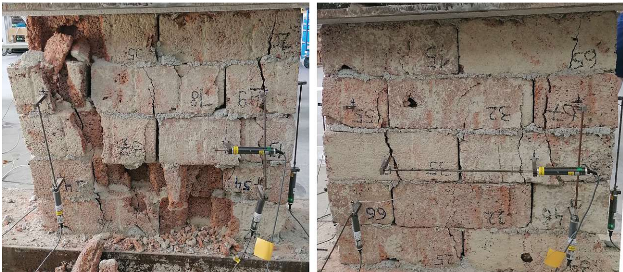
Abb. 5.34: Exemplarische Bruchformen der Längsseiten des RILEM-Pfeilers
