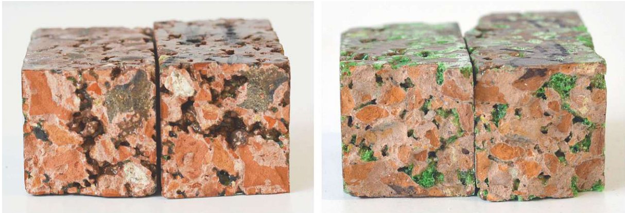
Abb. 5.22: Bruchbilder nach der Prüfung der Biegezugfestigkeit: Verfestigung durch Hydropox EP1 (links) und Pur-O-Stop FS-M (rechts)
