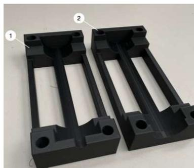
**Abbildung 4.4:** Unterteil der Kolbenhalterung mit Führung für Kolbenstange (1), Oberteil der Kolbenhalterung (2)
