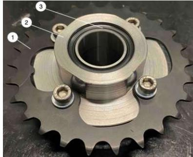
**Abbildung 4.2:** Kettenblatt der Antriebswelle, montiert auf einer Hülse mit Freilauf. 1...Kettenblatt, 2... Scheibe für Kettenblatt, 3...Freilauf
