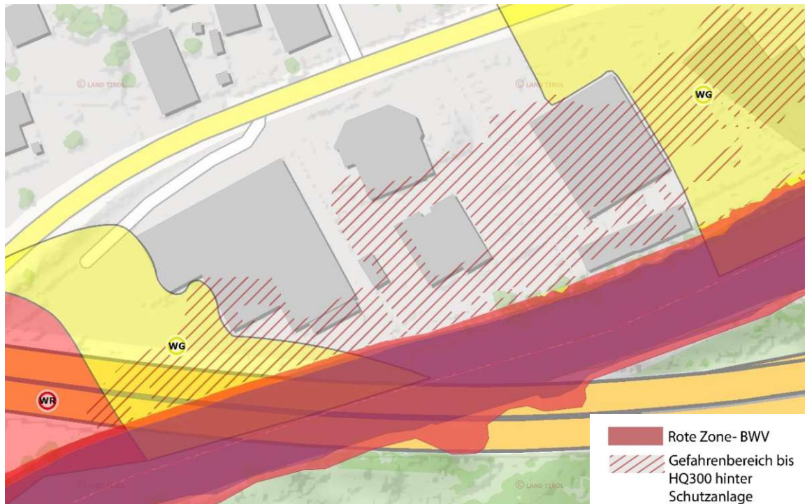
Abb. 41 HQ300 im Wirkungsbereich eines Hochwasserschutzbaus in Landeck, (TIRIS 2022)
