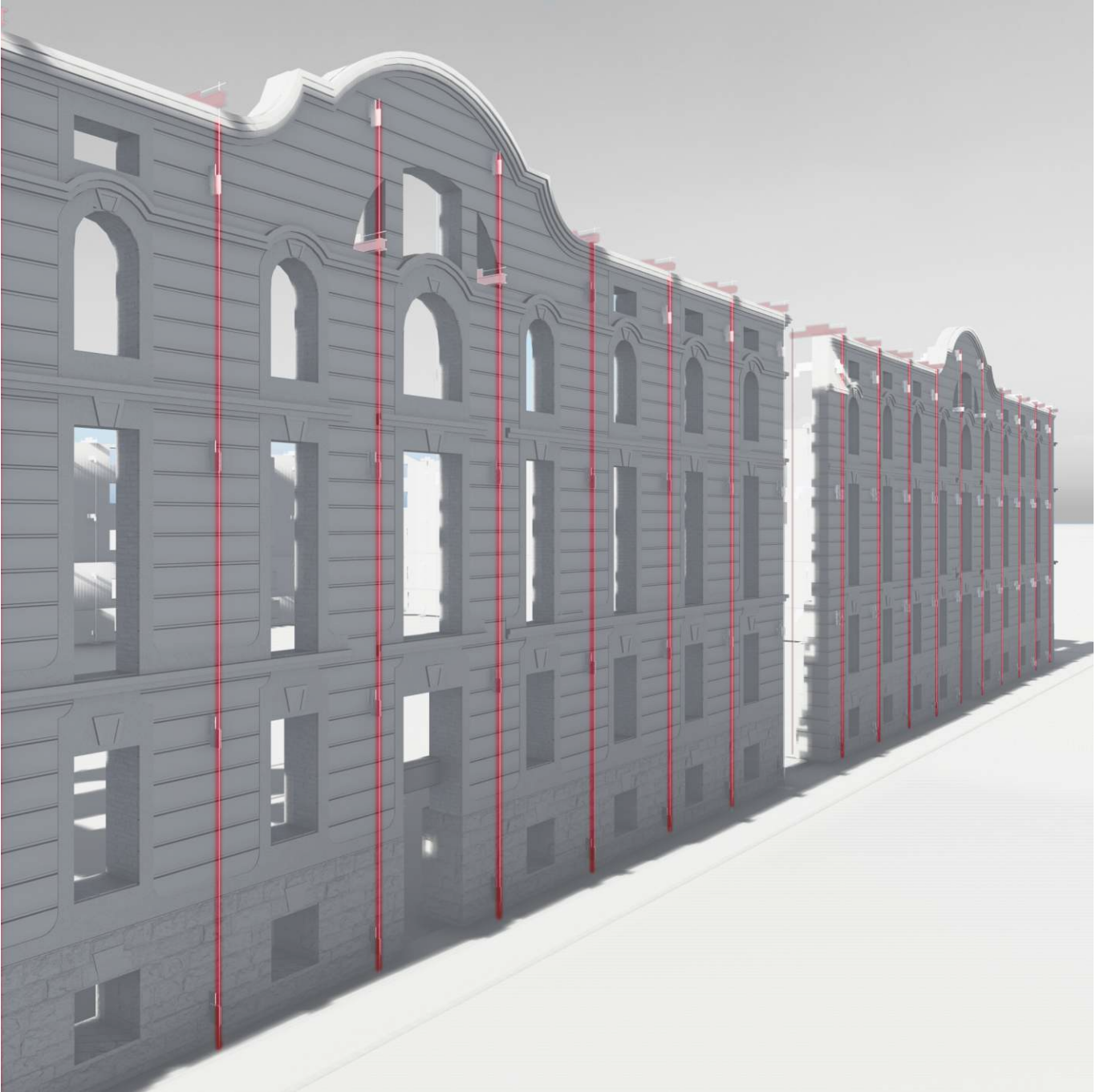
Abb. 67 Ansicht von der Verstärkungsstruktur auf der Fassade auf "Kapitan Andreev" Straße
