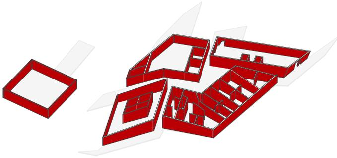
Die Massivbauweise umfasst massive Bauteile aus Beton oder Holzplatten und -scheiben. Zunächst wird das Fundament und die Bodenplatte errichtet, gefolgt von den tragenden Wänden und der Dachebene, die ebenfalls aus massiven Bauteilen bestehen.
