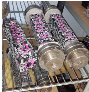
Abb. 4.2-8: Lagerung der geklebten Probekörper in Temperaturschrank bei 10°C
