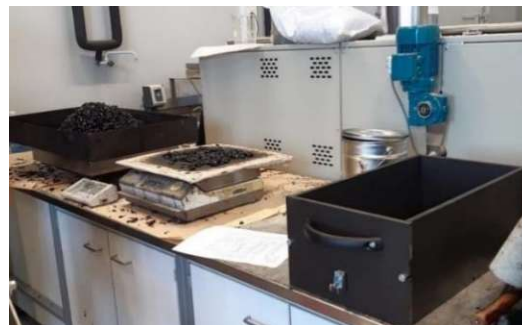
Abb. 4.2-3: Blechbox (Links) / Platte mit ummanteltem Tuch (Mitte) / Verdichtungsform Oberteil (Rechts)
