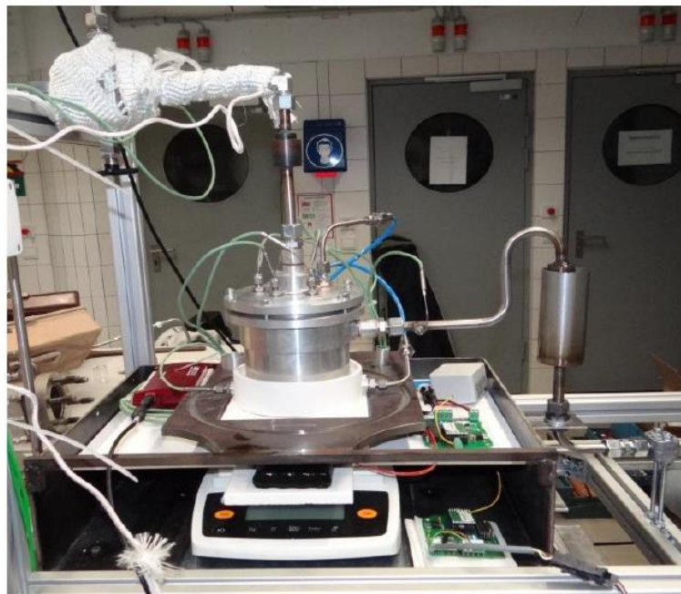
Abbildung 4-34: Wägereaktor während der Inbetriebnahme inkl. Abgasverrohrung (Florian Niederberger, 2015)
