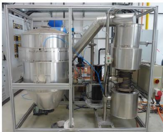
Abbildung 3-27: Wirbelschichtversuchsanlage (Alexander Bartik 2018)
