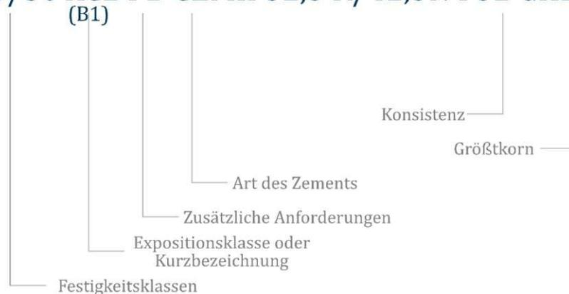
Abb. 32 Aufbau der Betonsortenbezeichnung
