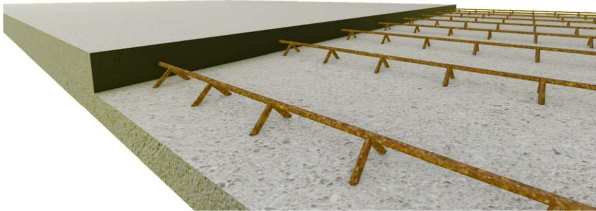
Abb. 16 Illustration einer Elementdecke<sup>48</sup>
