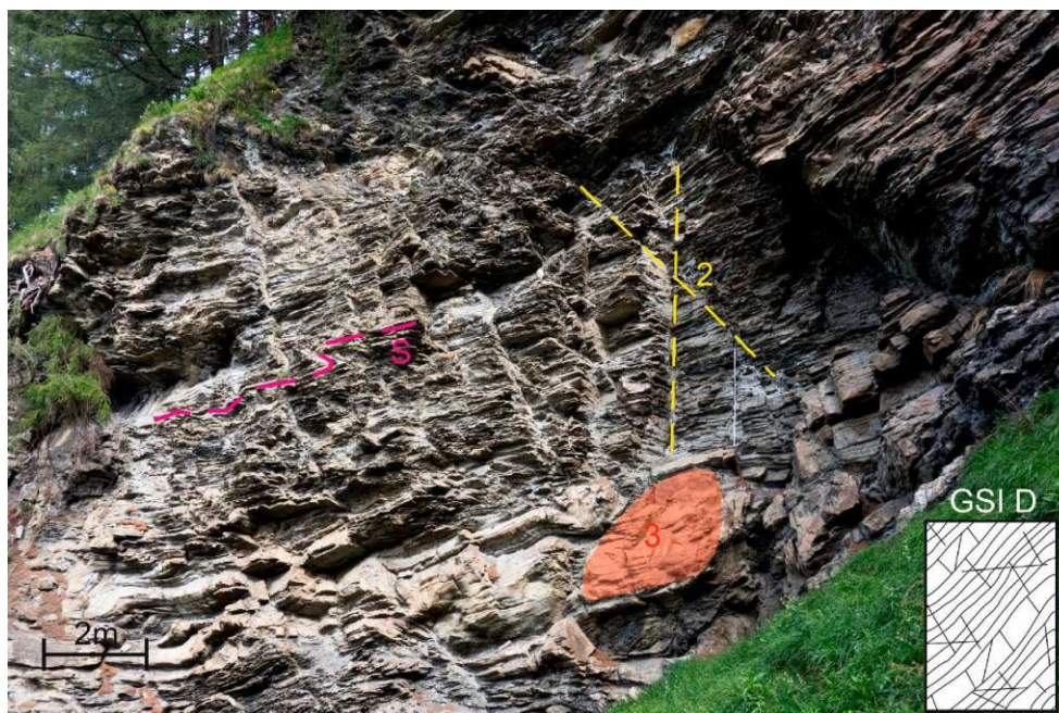
Abbildung 5-2: repräsentativer Aufschluss für das stark gefaltete und geklüftete Gebirge des Bündner Schiefer im Valsen Tal: S-Schieferung (magenta), 2-konjugierte Diskontinuitäten (gelb), 3-Störungsfläche (rot) (Illeditsch, Preh und Sausgruber 2022)
