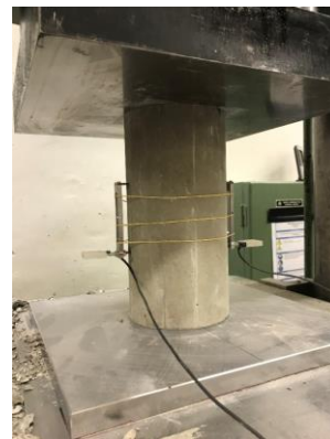
Abb. 3.22: Links: Darstellung des Versagens infolge Spaltzug am Probekörper, Rechts: Ermittlung des Elastizitätsmoduls
