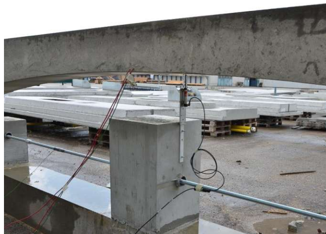
Abb. 3.19: Darstellung der angebrachten induktiven Wegaufnehmer
