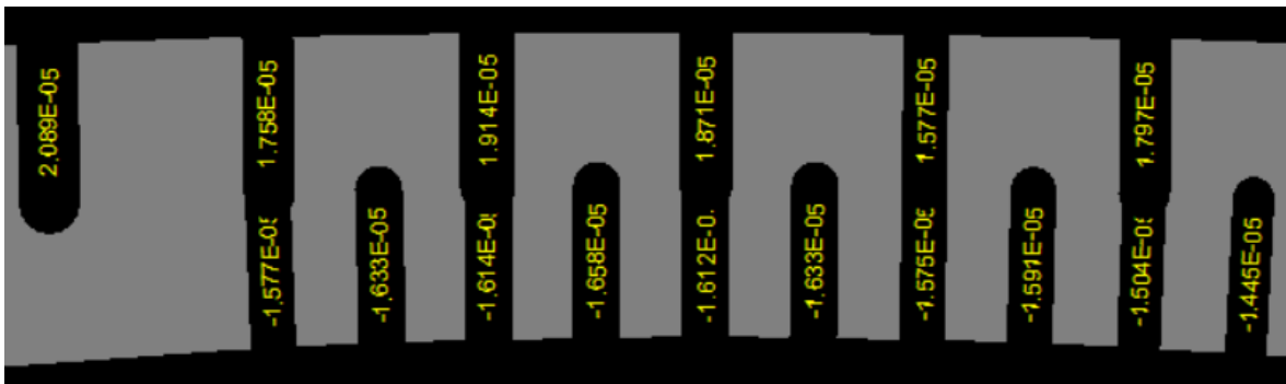
Abb. 3.109: Step 70 (Erwärmung um +20\text{ °C} ) - Rissbild im Scheitelbereich von Bogen 1 [m]
