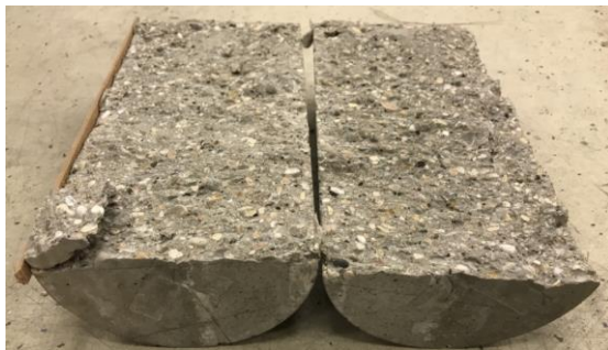
Abb. 3.22: Links: Darstellung des Versagens infolge Spaltzug am Probekörper, Rechts: Ermittlung des Elastizitätsmoduls
