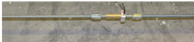
Abb. 3.16: Darstellung des angebrachten Zugmessglieds
