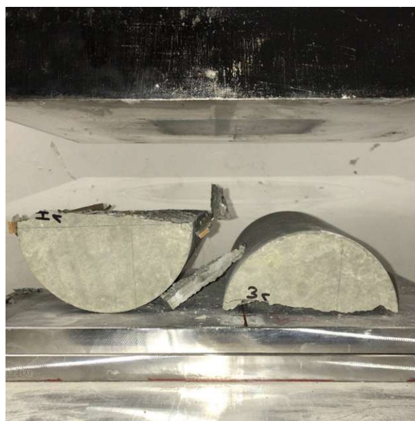
Abb. 23: Prüfung der Spaltzugfestigkeit - Versagensbild
