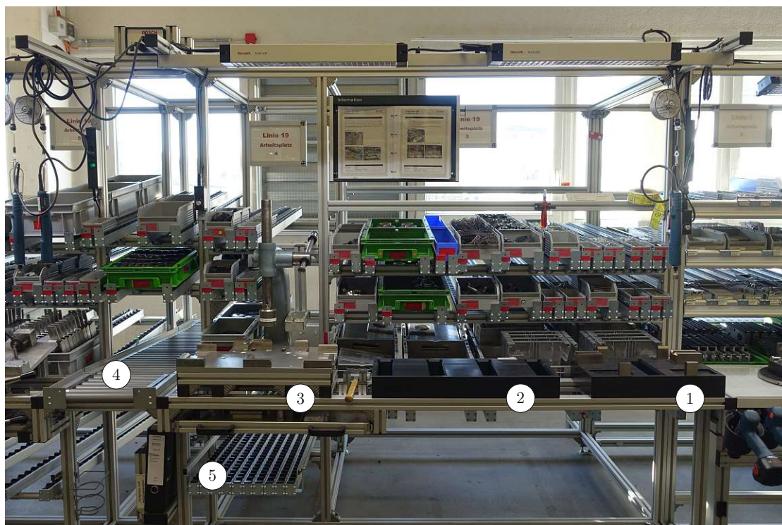
Abbildung 9.3.: Arbeitsplätze zur Bestückung der Gehäuse der Antriebsstationen AS 2/C und AS 2/R
