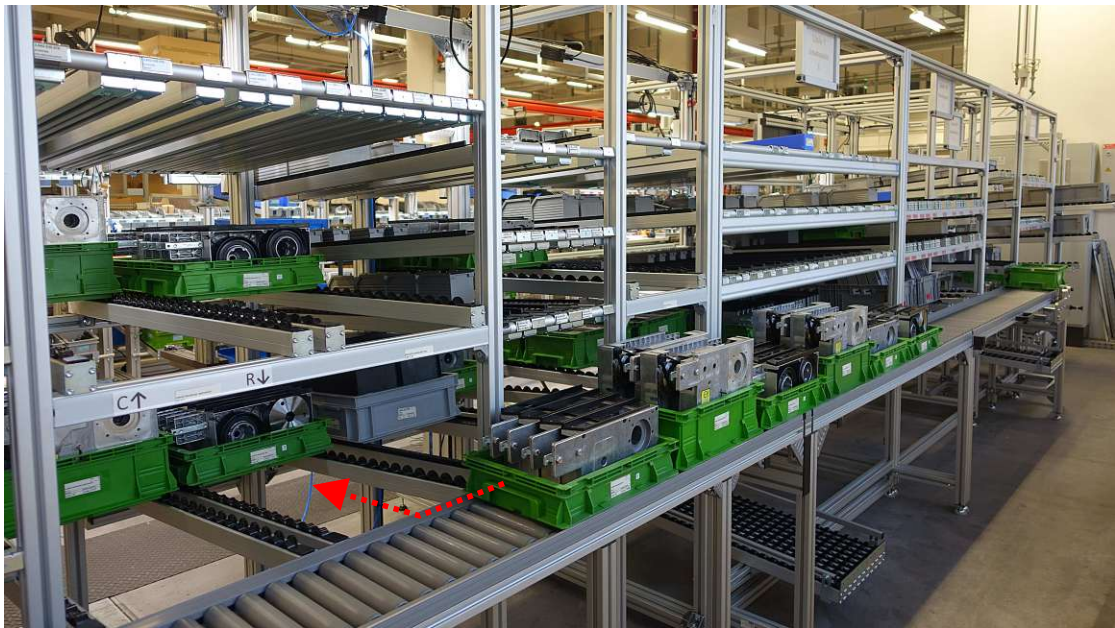
(b) Einsortieren der Behälter an der Rückseite der Endmontage
