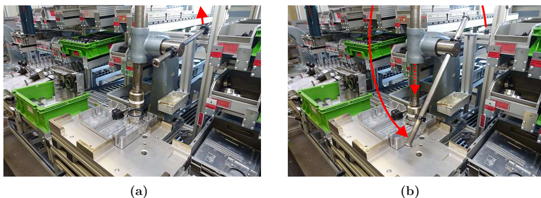
Abbildung 9.9.: Einpressen des Lagers
