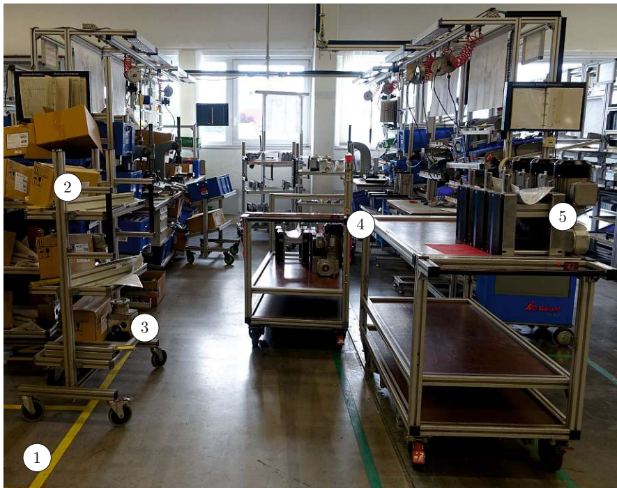
Abbildung 7.4.: Blick in die alte Linie mit 1. Fläche für Auftragswägen, 2. Auftragswägen, 3. auftragsbezogene Teile, 4. Ablieferwägen und 5. fertige Antriebsstationen (AS 2/B-150, MA=R)
