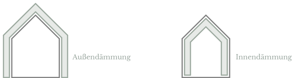
Abb. 17: Außendämmung vs. Innendämmung
