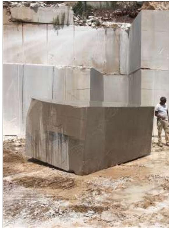
Abb. 4. Insel Brač, Steinbruch zur Ausbeutung von Architektur- bzw. Bausteinen
