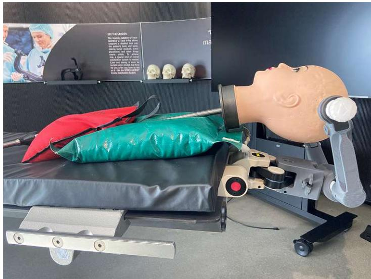
Abbildung 7.9: Die Tischplatte und der Parallelogramm-Adapter mit der angepassten Parallelogramm-Klaue wird am Operationstisch befestigt. Der Patientenkopf wurde in der Schädelschlinge fixiert und die Verbindung der beiden Komponenten hergestellt
