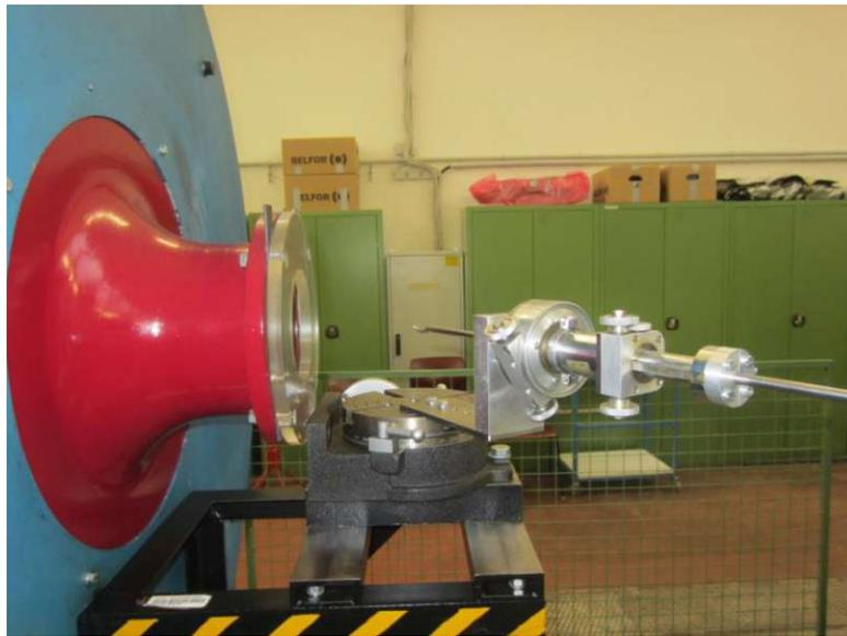
**Abbildung 6.1: Alte Verstelleinrichtung inklusive Strömungssonde [7]**
