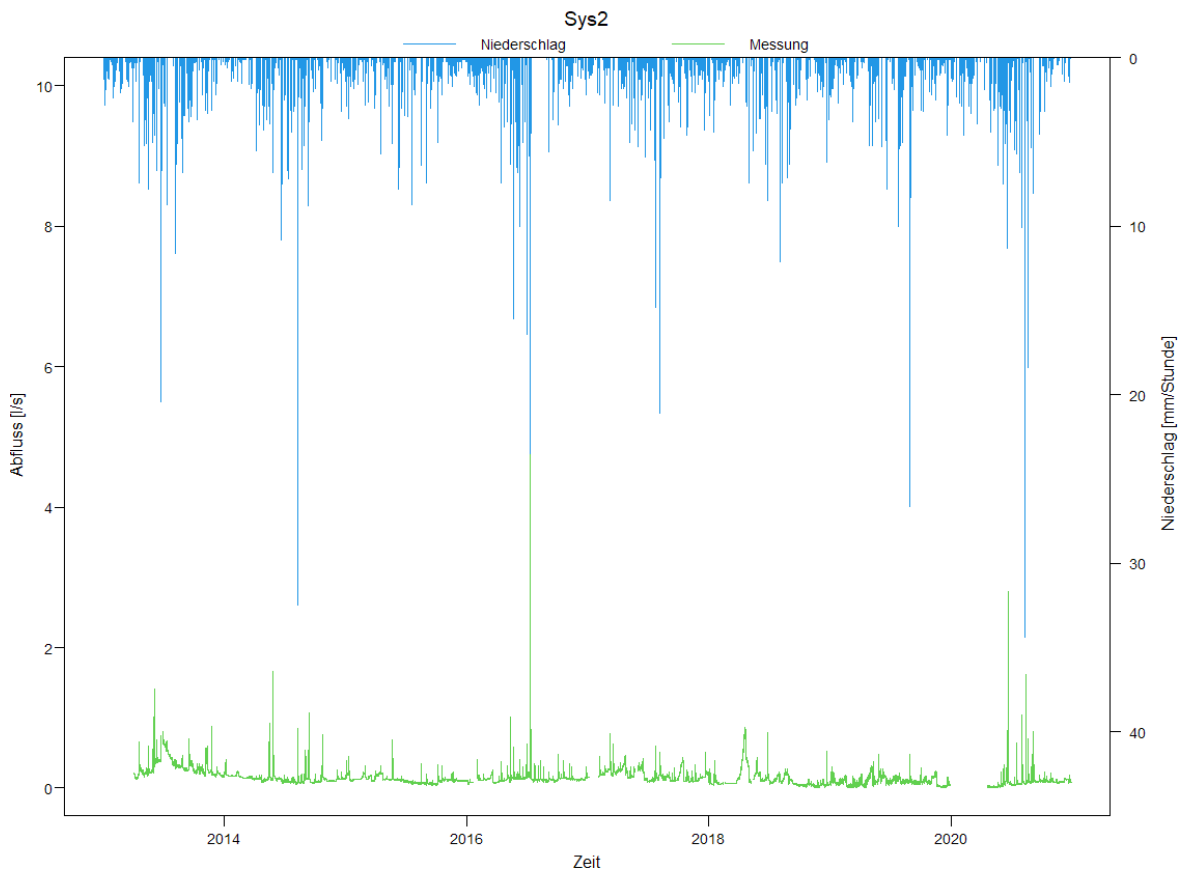
Abbildung 74: Gemessener Durchfluss an der Messstelle Sys2
