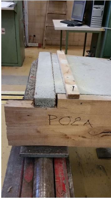
Abbildung 171: Träger P02A auf den Auflagern seitlich ist die Schraube HEKO-MMS TC im Balken sichtbar
