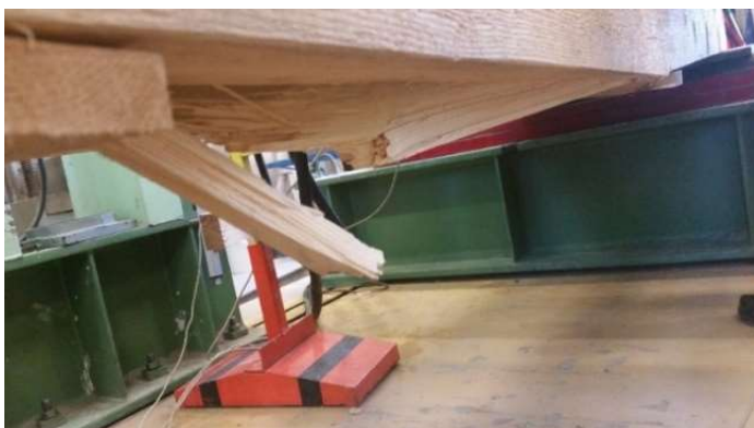
Abbildung 195: Bersten des Balkens P01A
