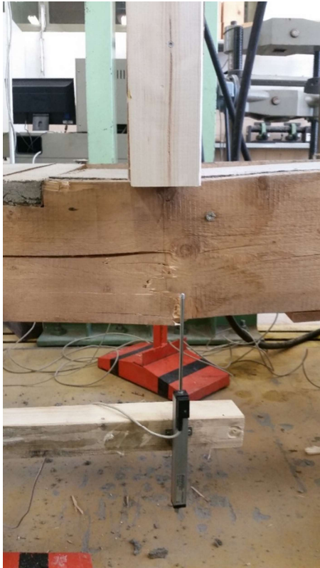
Abbildung 207: Bruch des Balkens in der Nähe eines Astes
