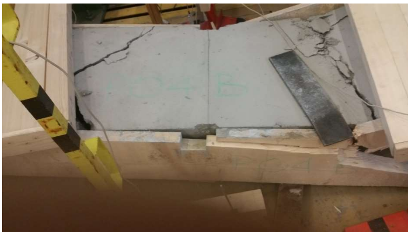
Abbildung 218: Bruch der Betonplatte an beiden Belastungspunkten beim Bauteil P04B
