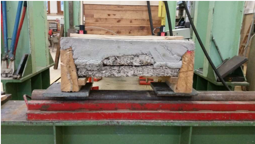
Abbildung 212: Bauteil P04A im Querschnitt vor dem Bruch. Deutlich ist zu sehen, wie die zweite VELOX-Platte den Querschnitt stabilisiert.
