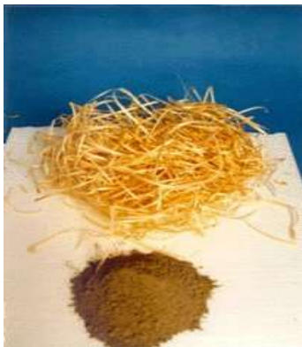
Abbildung 64: Pappelholzwolle und Mineralpulver zur Herstellung von Tarolit (aus http://www.tarolit.co.rs/Classic1/index2.html )
