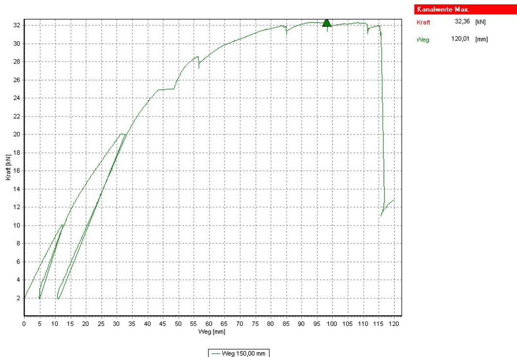
Abbildung 215: Kraft-Weg-Diagramm vom Bauteil P04A. Der Bruch tritt bei 32,36 kN ein und die Durchbiegung beträgt 12 cm. Die Durchbiegungen sind nach den Durchgängen deutlicher zu sehen. Beim dritten Durchgang der Belastungen ist schon eine Grunddurchbiegung von 10 mm zu sehen.
