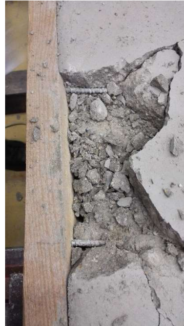
Abbildung 172: Träger P02A nach dem Bruch, die Betonschicht wurde geöffnet, die HEKO MMS TC sind deutlich sichtbar
