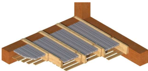
Abbildung 251: Decke mit Betonschicht
