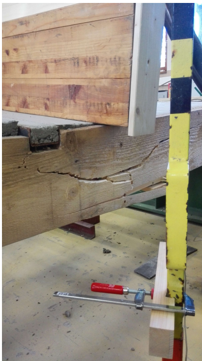
Abbildung 199: Beginnender Bruch Am Bauteil P02A
