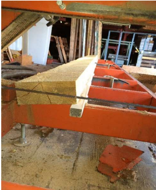
Abbildungen 153 und 154: Balken auf der Wood Mizer LT 15 vor und während dem Schnitt
