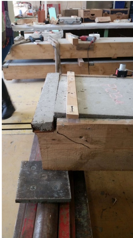
Abb.208: Verschiebung der Betonplatte nach Bruch
