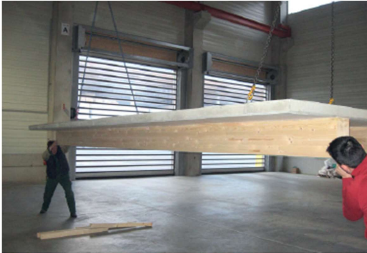
Abbildung 122: Prototyp eines TT-Elements mit 6 m Spannweite (Becker und Götz 2012)
