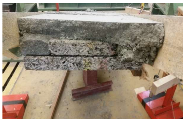
Abbildung 214: Bruch der Holzbeton-Verbindung und der Velox-Platte (Bauteil P04A)
