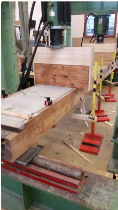
Abbildungen 185 und 186: Anordnung des Bauteils P01 in der Prüfanlage mit angebrachten Sensoren zur Messung der Durchbiegung und zur Verschiebung des Betons. Die Anordnung der digitalen Wegaufnehmer ist bei allen Bauteilen dieser Versuchsreihe gleich.
