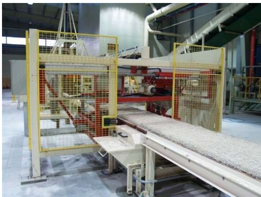
Abbildung 109: Holzwolle wird auf dem Förderband angeordnet
