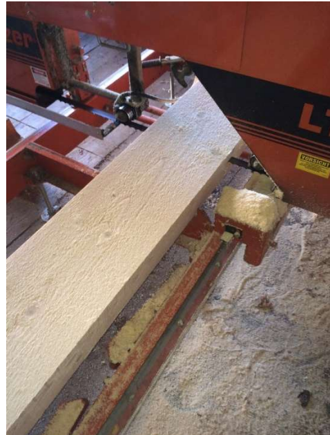
Abbildungen 153 und 154: Balken auf der Wood Mizer LT 15 vor und während dem Schnitt
