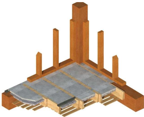
Abbildung 253: Wandtragwerk aus Holzbalken
