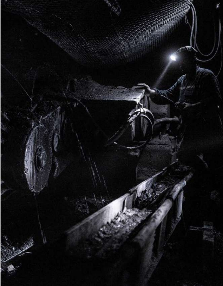
Abb.54 ein Bergmann bedient einen Brecher, der das abgebaute Material zerkleinert und transportfähig macht. Die Arbeit unter Tage findet oft unter Feuchtigkeit, Kohlestaub, Dunkelheit, Zugluft oder hohen Konzentrationen von Methangas statt.
