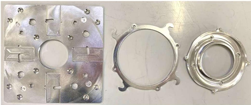
Abbildung 48: Gefertigte Befestigungsplatte, Hakenscheibe und Halterung
