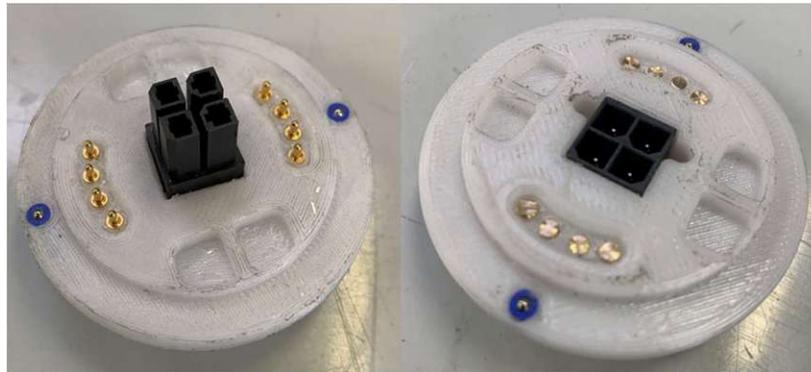
Abbildung 50: Prototypen des männlichen (links) und weiblichen (rechts) Steckersystems
