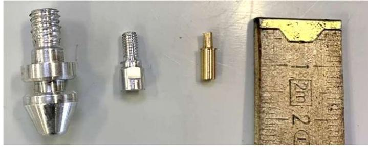
Abbildung 49: Gefertigte Befestigungsbolzen, Öffnungsbolzen und Kontaktstift
