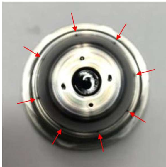
Abbildung 42: Punktuelle Ablagerung von Verunreinigungen radial am Anbindungsteil
