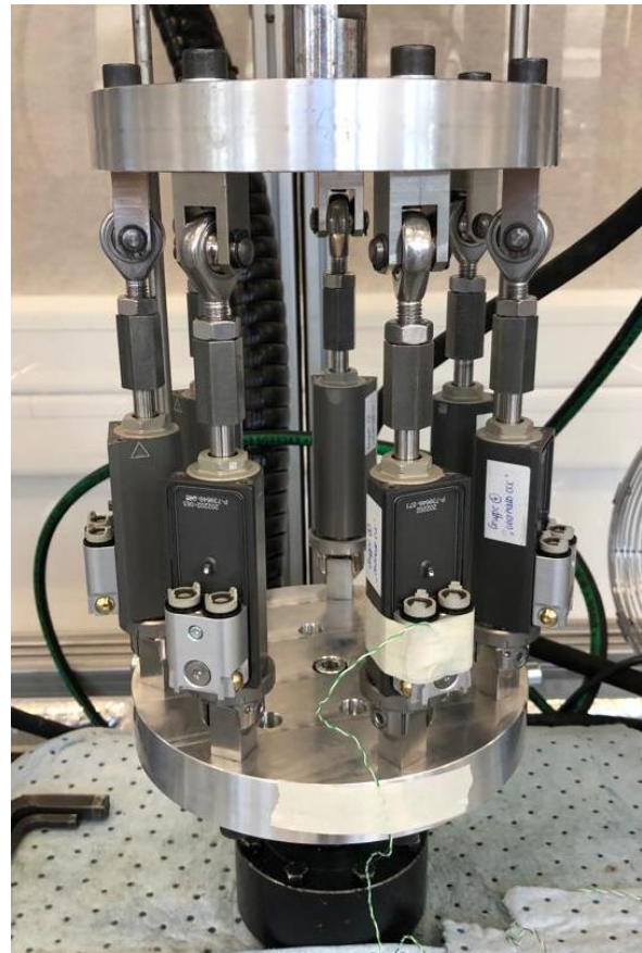
Abbildung 26: Aufspannung der sieben Hydraulikprüflinge auf die Prüfmaschine während des Dauertests. Links: Ventilatoren zur Kühlung
