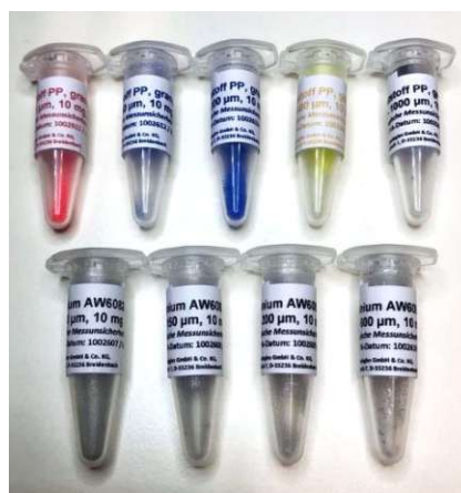
Abbildung 18: Normpartikel der Firma BIDAG. Polypropylen-Partikel mit bunten UV-Indikatoren (oben) und Aluminiumpartikel (unten)
